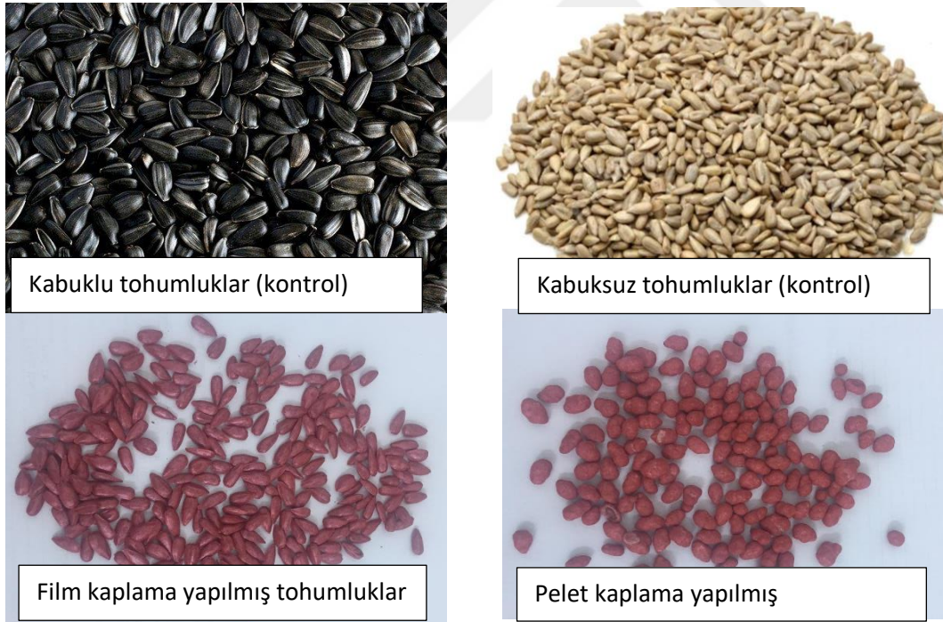
řekil 3.2. Kontrol grupları, film ve pelet kaplama yapılmıř tohumluklar
