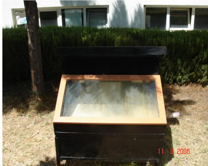
Şekil 3.4 Doğal akımlı model kurutucunun önden görünüşü
