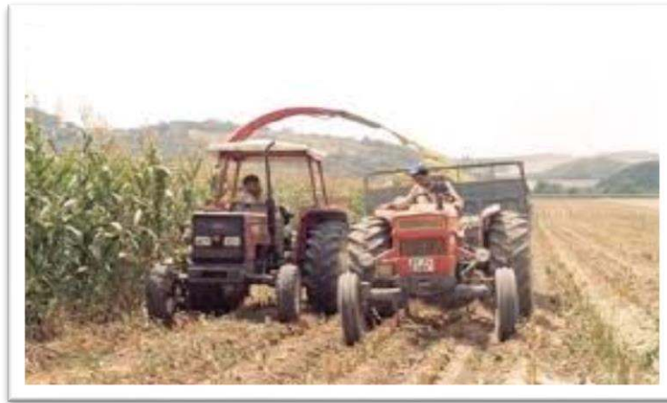
Şekil 8. Traktöre Bağlanan Silaj Makinası
