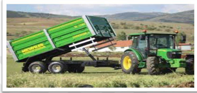
Şekil 5. Silaj taşıma hidrolik kasalı tarım arabası.
