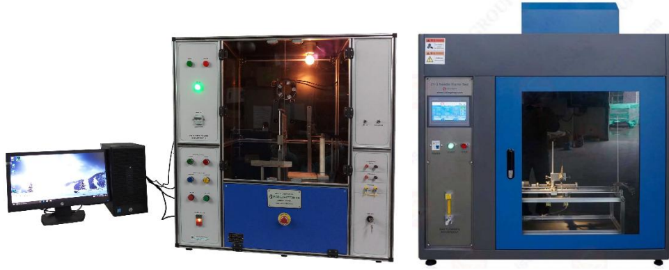
Görsel 6.8. Kızaran tel test cihazı (SCR Elektronik PVT. LTD., 2025) ve iğne alev test cihazı (LISUN GROUP, 2025)
