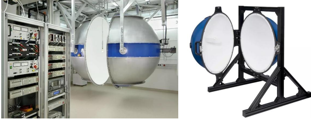
Görsel 6.3. Ulbricht Küresi (Opsytec Dr. Gröbel, 2025)
