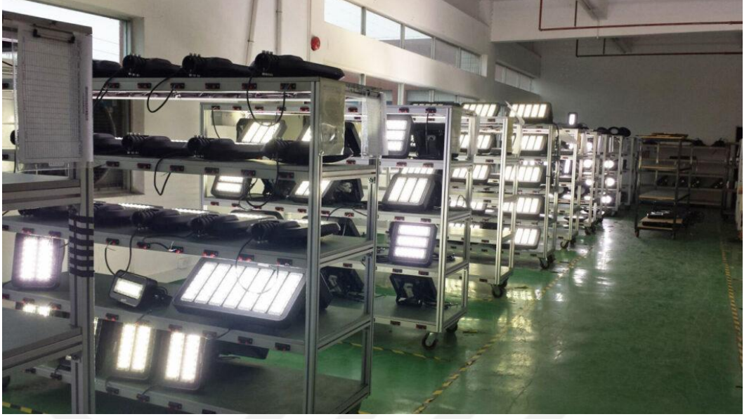
Görsel 6.10. Aydınlatma armatürleri ömür testi odası (Aydınlatma Portalı, 2025)
