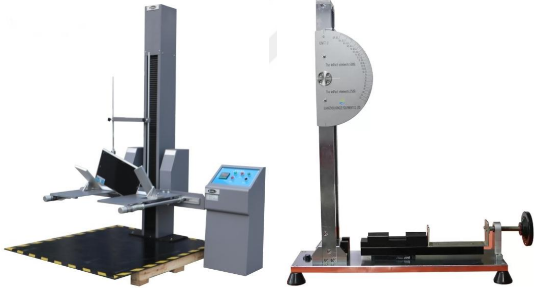
Görsel 6.6. Düşen ağırlık test cihazı (ASLI, 2025) ve çekiçli darbe test cihazı (Guangzhou HongCe Equipment Co., Ltd., 2025)
