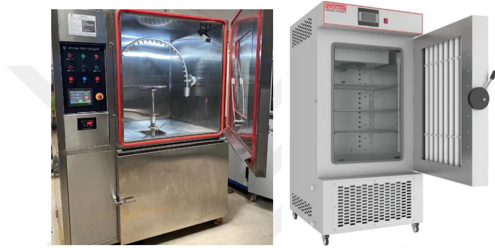
Görsel 6.7. Yağmur test kabini (Indiamart, 2025) ve iklimlendirme test kabini (EUROLAB, 2025)
