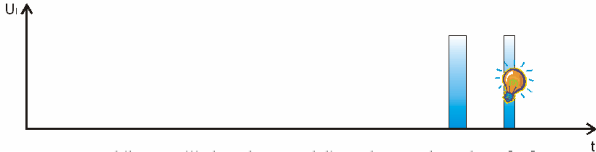
Şekil 2.43 Dijital ateşleme modeli – Tekrar sıcak ateşleme [10]
