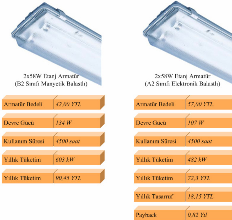
Şekil 3.18 Manyetik balast – elektronik balast enerji tüketim değerlendirmesi-2
