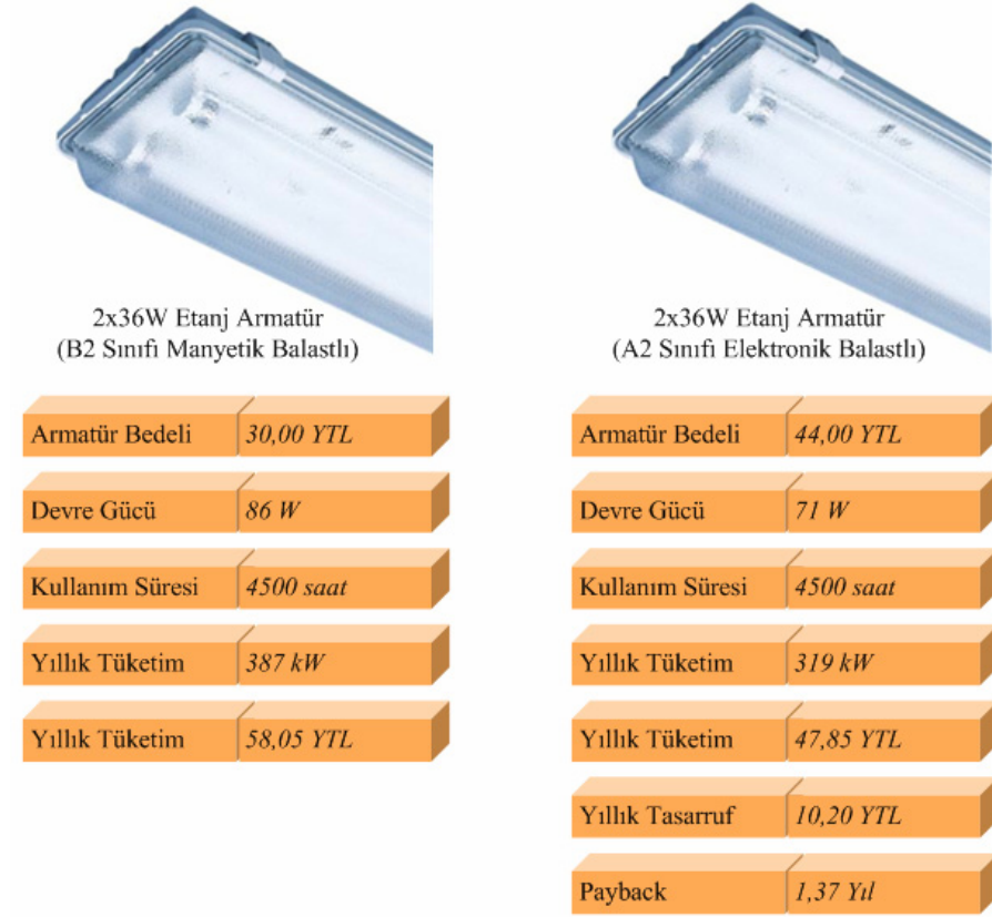
Şekil 3.17 Manyetik balast – elektronik balast enerji tüketim değerlendirmesi
