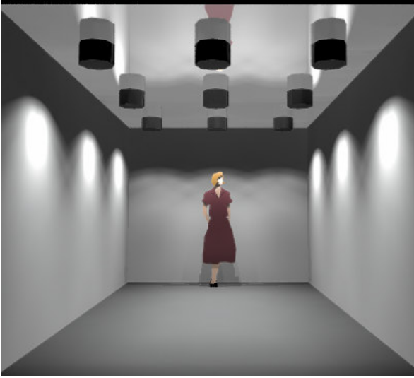
Şekil 9.37 DIALux programında POV-RAY ile 5 no'lu tavan yüzeyinin parlak malzeme etkisinin görselleştirilmesi
