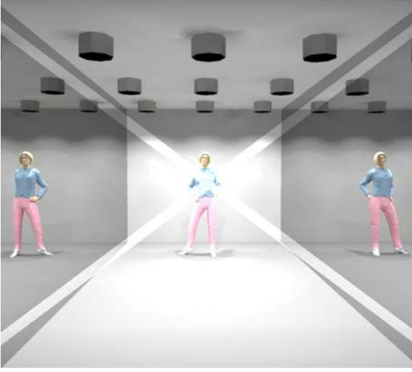
Şekil 9.41 Relux programında Relux Vision 1.1 ile 1 ve 3 no'lu duvarda parlak malzeme etkisinin görselleştirilmesi.
