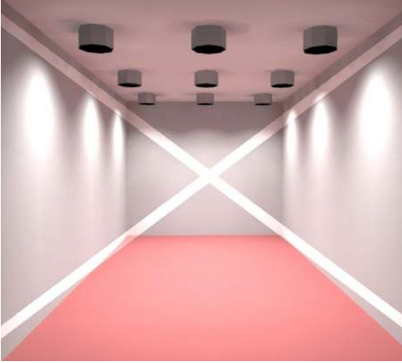
Şekil 9.48 Relux programında Relux Vision 1.1 ile türlü yüzeyli döşeme görselleştirilmesi (Döşeme Kırmızı RGB 255, r=%20).
