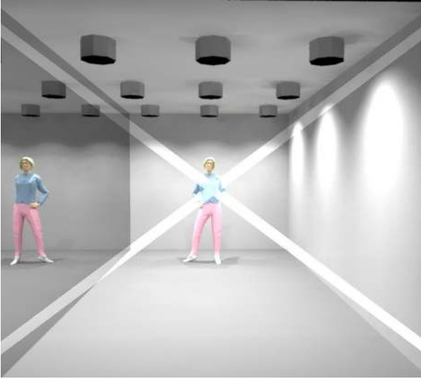
Şekil 9.40 Relux programında Relux Vision 1.1 ile 1 no'lu duvarda parlak malzeme etkisinin görselleştirilmesi.
