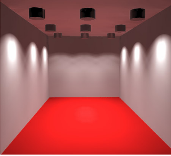
Şekil 9.47 DIALux programında POV-RAY ile türlü yüzeyli döşeme görselleştirilmesi (Döşeme Kırmızı RGB 255, r=%20).
