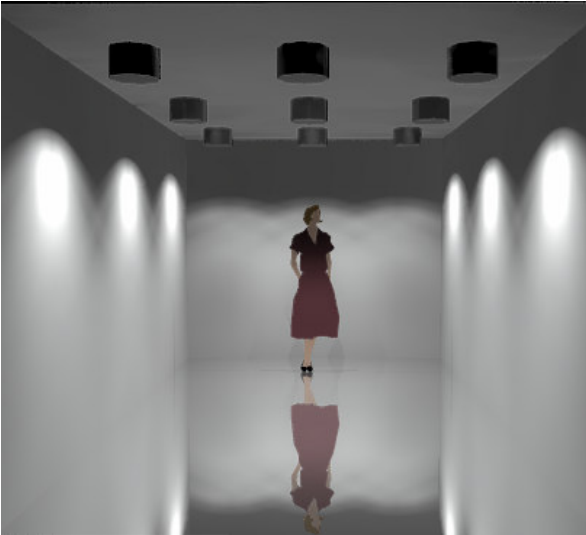
Şekil 9.38 DIALux programında POV-RAY ile 6 no'lu döşeme yüzeyinin parlak malzeme etkisinin görselleştirilmesi.
