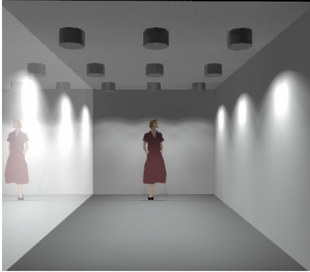
Şekil 9.34 DIALux programında POV-RAY ile 1 no’lu yüzeyde parlak malzeme etkisinin görselleştirilmesi.
