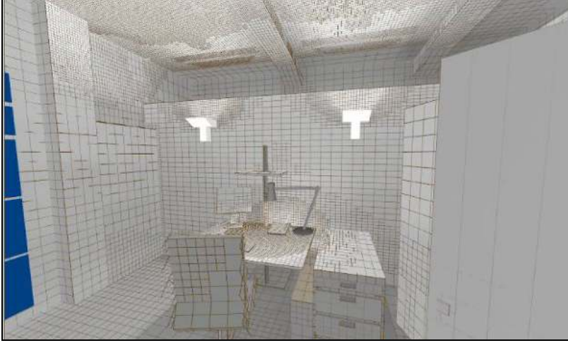
Şekil 3.2 DIALux programında aydınlık düzeyi hesabı için yüzeylerin bölümlere ayrılması.
