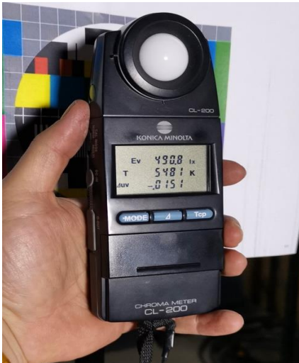
Resim 5.8. Balcar quadlite flüoresan lamba ölçüm verileri.
