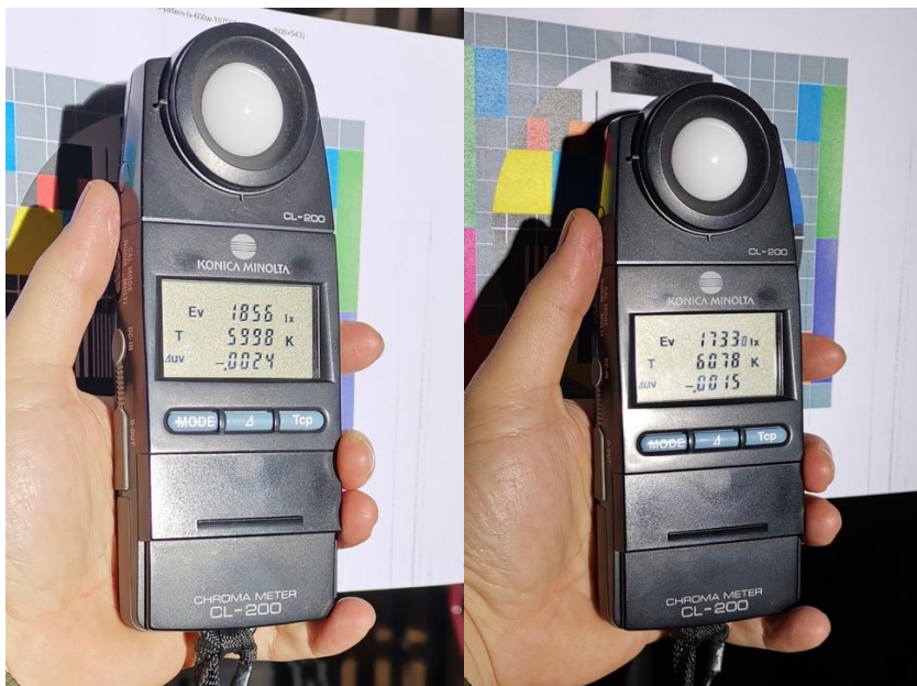
Resim 5.5. De sisti 575 W projektörün solda dağınık, sağda odaklı ölçüm verileri.
