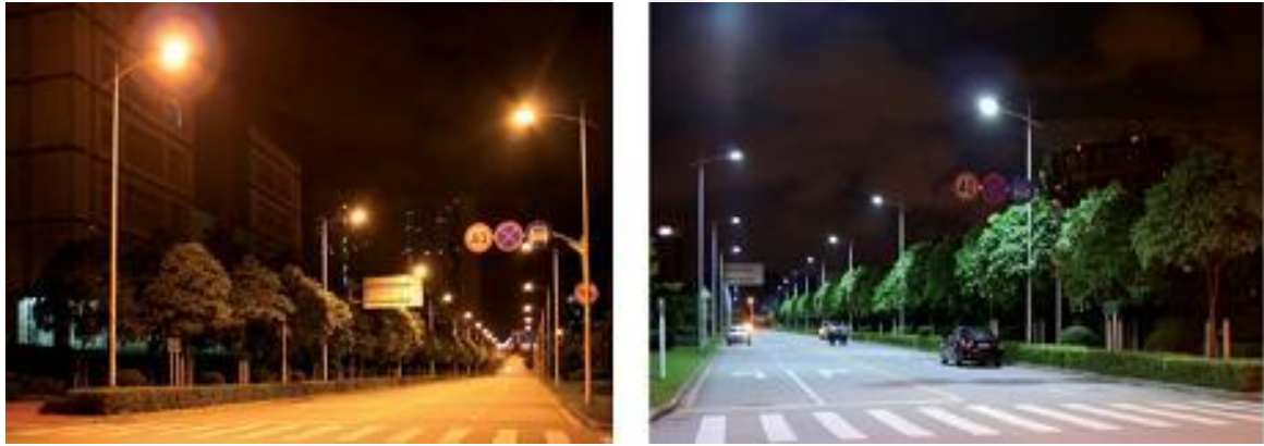
Şekil 2.43. Sodyum buharlı lamba ile LED'li armatürlerin görsel farkı [41].
