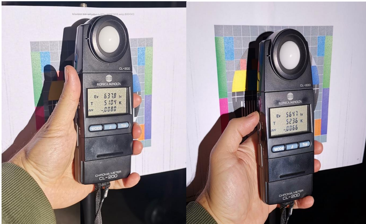
Resim 5.2. ARRI compact 200 lamba solda dağınık, sağda odaklı ölçüm verileri.
