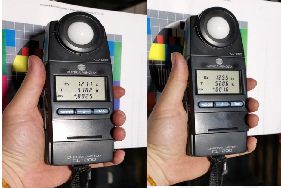
Resim 5.9. ARRI Skypanel S60-C solda 3200 K, sağda 5600 K ölçüm verileri.
