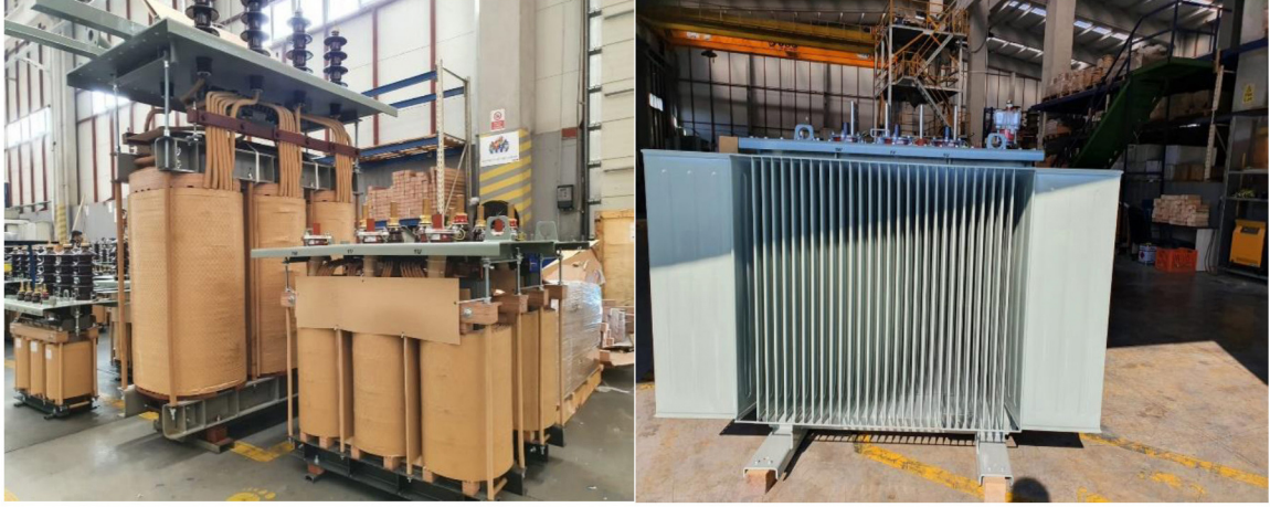
Resim 2.1. Transformatörün aktif kısmı ve tamamlanmış hali
