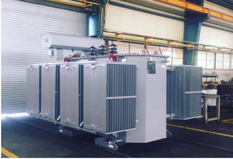
Resim 2.2. Büyük dağıtım transformatörü
