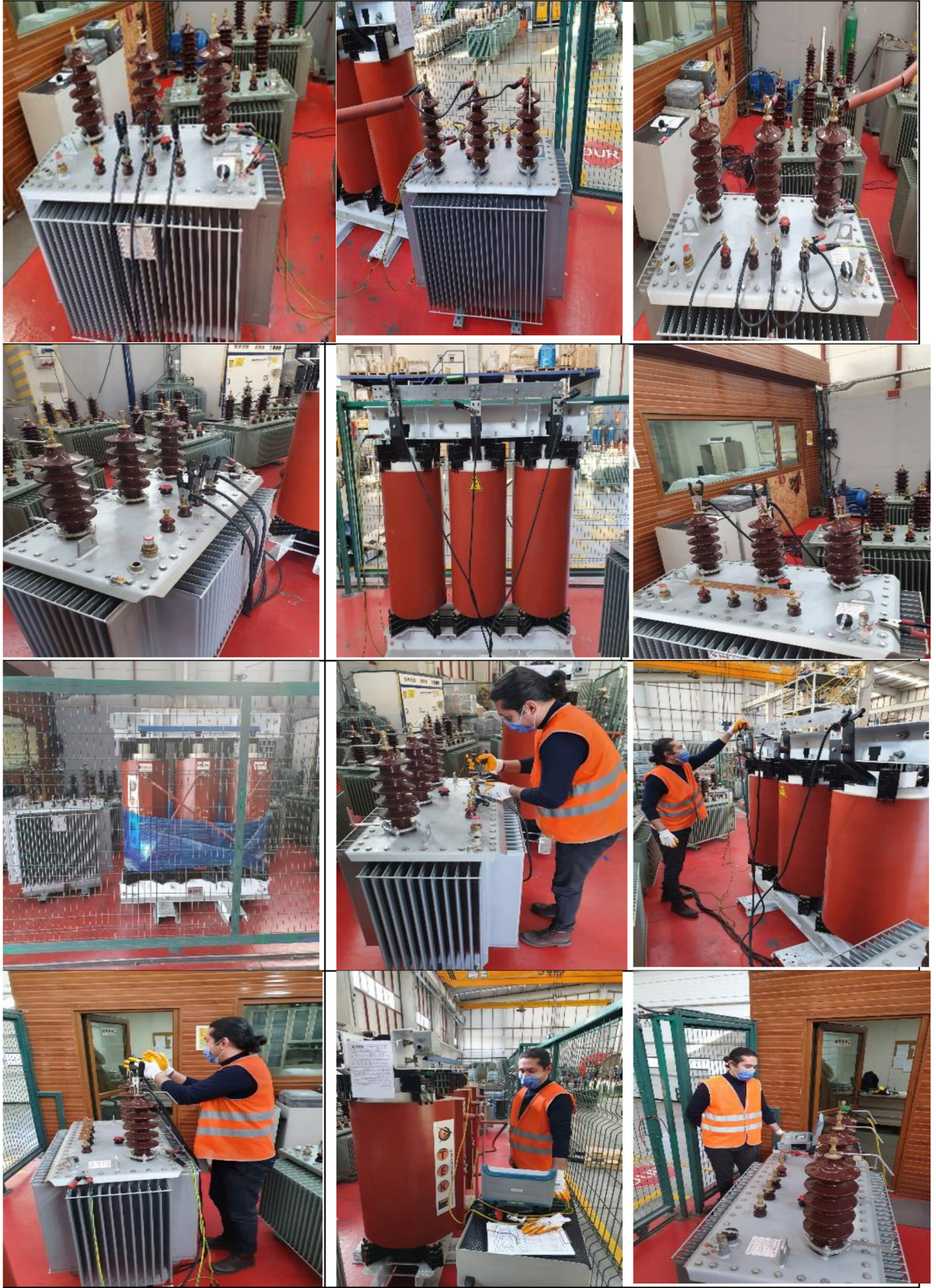
Resim 4.1. Tek transformatör akredite labratuvarında rutin testlerin yapılması
