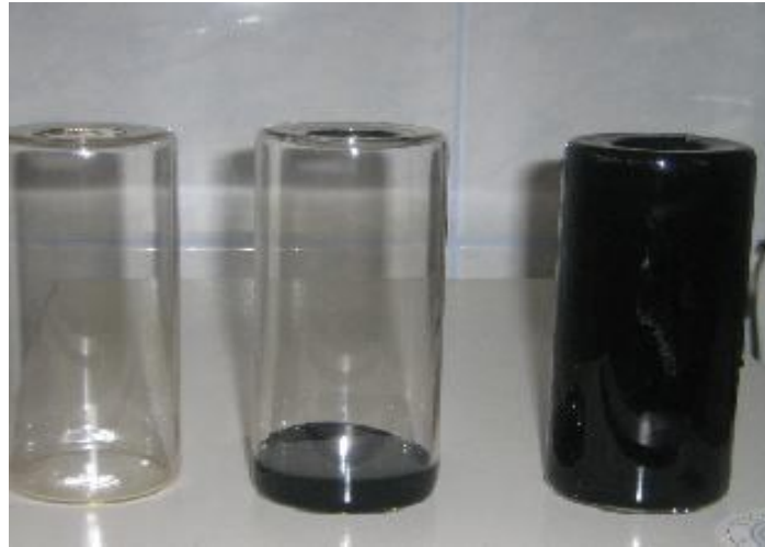
Şekil 3.12. Dönel ince film halinde ısıtma deneyi öncesi ve sonrasında şişelerin görünümü
