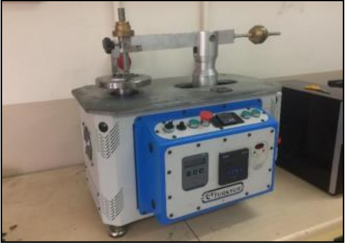
Şekil 13.2: Ball-on-Disk Deney cihazı.
