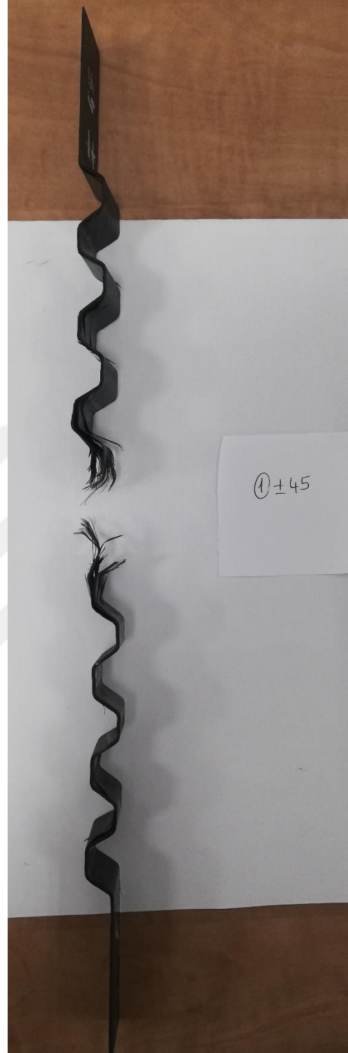
Şekil 15.2: \pm 45 Derece 1. Numune Test Sonrası
