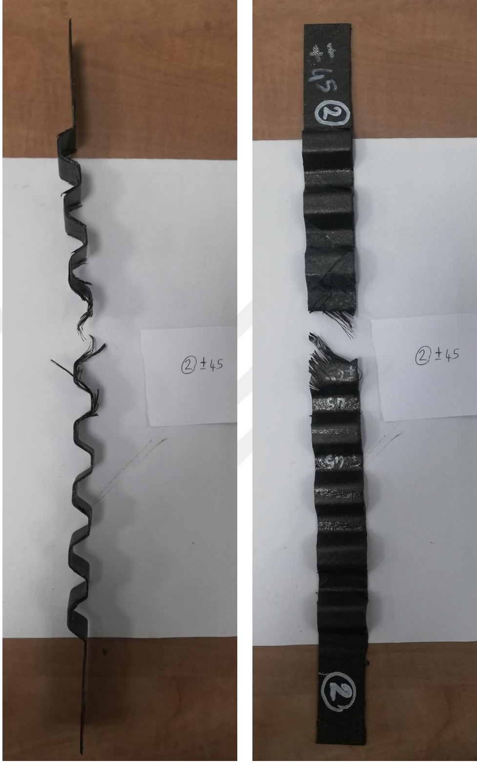
Şekil 15.3: \pm 45 Derece 2. Numune Test Sonrası
