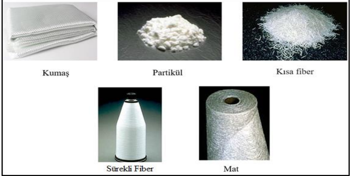
Şekil 3.1: Çeşitli formlarda takviye malzemeler
