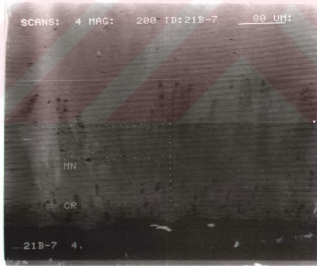
Şekil 4.58. Fe-%0.3 C-%0.02 P-%0.5 Mn-%0.5 Cr Bileşimindeki Numunenin (a) SEM-BEI (Backscatter Electron Image) Bileşim Kontrastı Görüntüsü (b) Çizgi Boyunca Mn ve Cr Elementlerinin Dağılımı (Borlama Süresi : 7 Saat)
