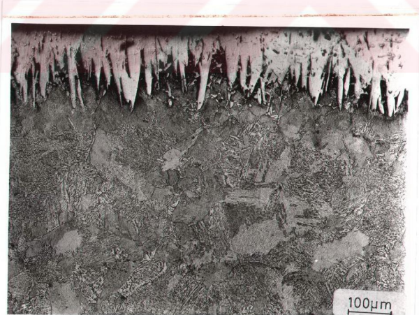
Şekil 4.23. 940°C'de 10 Saat Borlanmış Fe-0.3 C-0.02 P-1 Cr Bileşimindeki Numunenin Mikroyapısı. X120.2 Nital.
