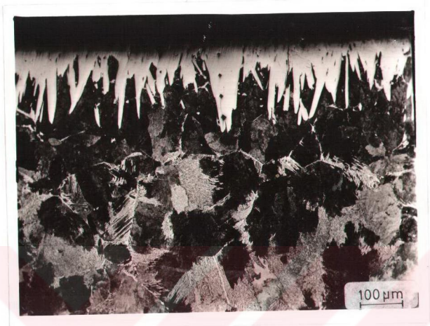
Şekil 4.24. 940°C'de 10 Saat Borlanmış Fe-%0.3 C-%0.02 P-%0.5 Mn-%0.5 Cr Bileşimindeki Numunenin Mikroyapısı. Kaplama Tabakası ve Matrisde Vickers Sertlik İzleri Gö-rülmektedir. X120. %2 Nital.
