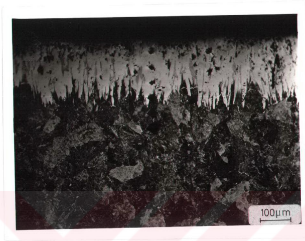
Şekil 4.18. 940°C'de 7 Saat Borlanmış, AISI 1050 Çeliğinin Mikroyapısı. Kaplama Tabakası ve Matrisde Vickers Sertlik İzleri Görülmektedir. X120. %2 Nital.
