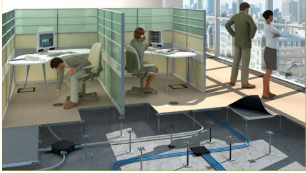
Resim 6. Yükseltilmiş Döşeme Örneği
