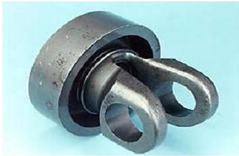
Şekil 4.14. Sürtünme kaynağı ile imal edilmiş dizel motor pistonu [27].
