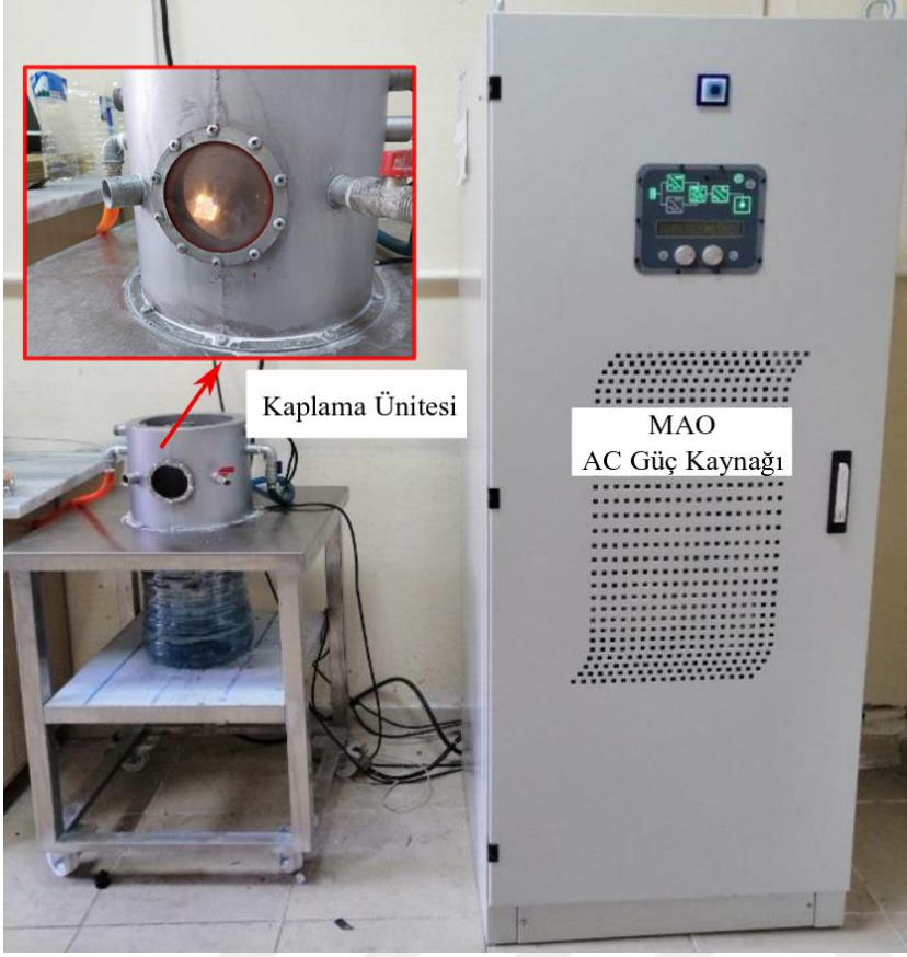
Şekil 3.3. MAO işleminde kullanılan sistemin şematik görüntüsü
