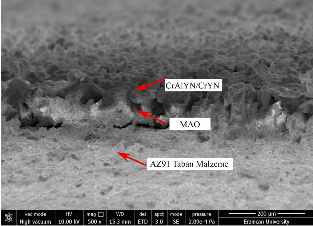
Şekil 4.37. R2 deney şartlarında AZ91 alaşımı üzerine büyütülen dubleks kaplamanın kesit görüntüsü
