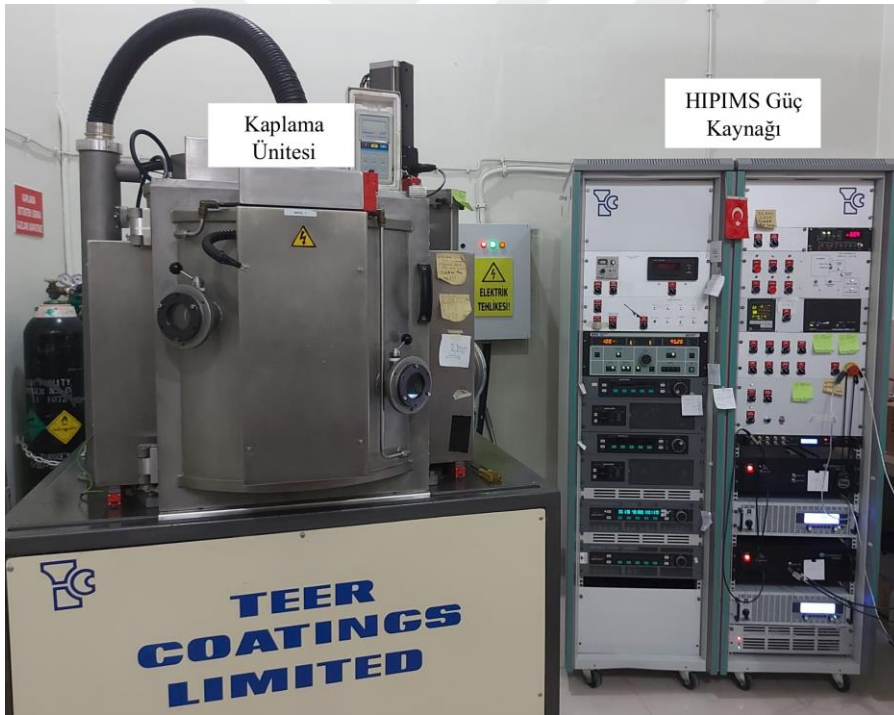
Şekil 3.4. HiPIMS-PVD işleminde kullanılan düzeneğin görüntüsü
