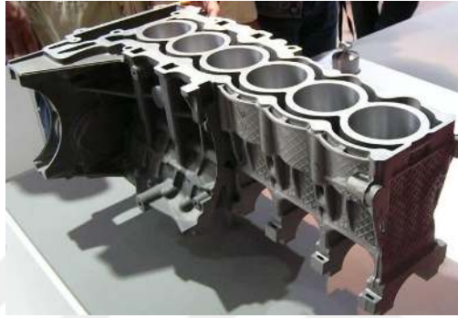
Şekil 1.18. Mg-Al-Si kullanılarak üretilen motor bloğu (Andreas, vd., 2005).
