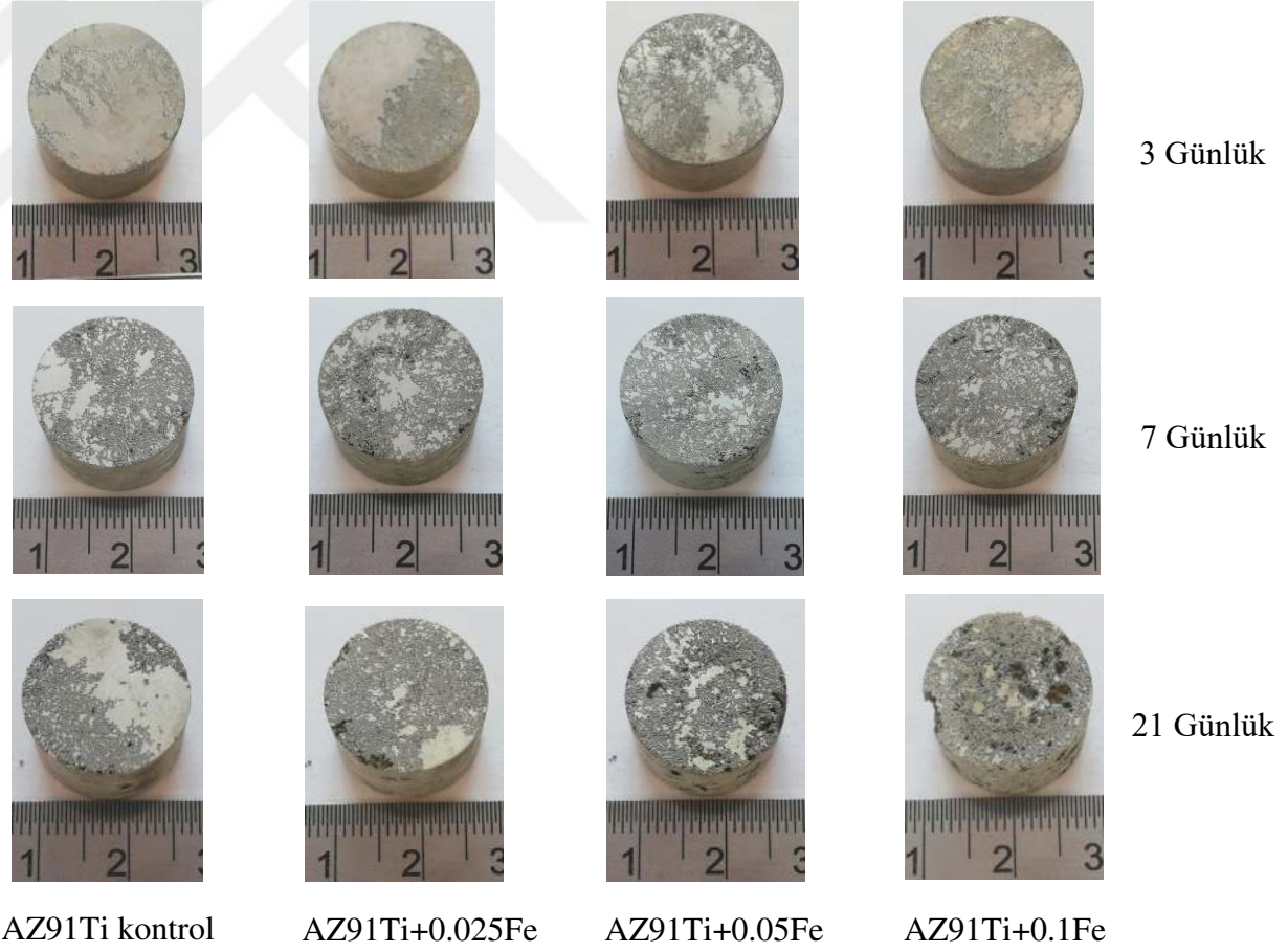
Şekil 4.8. AZ91Ti Mg alaşımının Fe oranına bağlı korozyon sonrası AZ91Ti Kontrol, AZ91Ti+0.025Fe, AZ91Ti+0.05Fe ve AZ91Ti+0.1Fe makroyapı resimleri.
