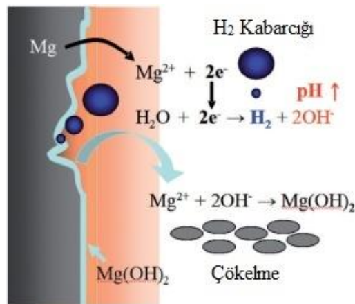
Şekil 2.2. Sulu ortam içerisinde Mg çözünmesi (Yun, vd., 2009).
