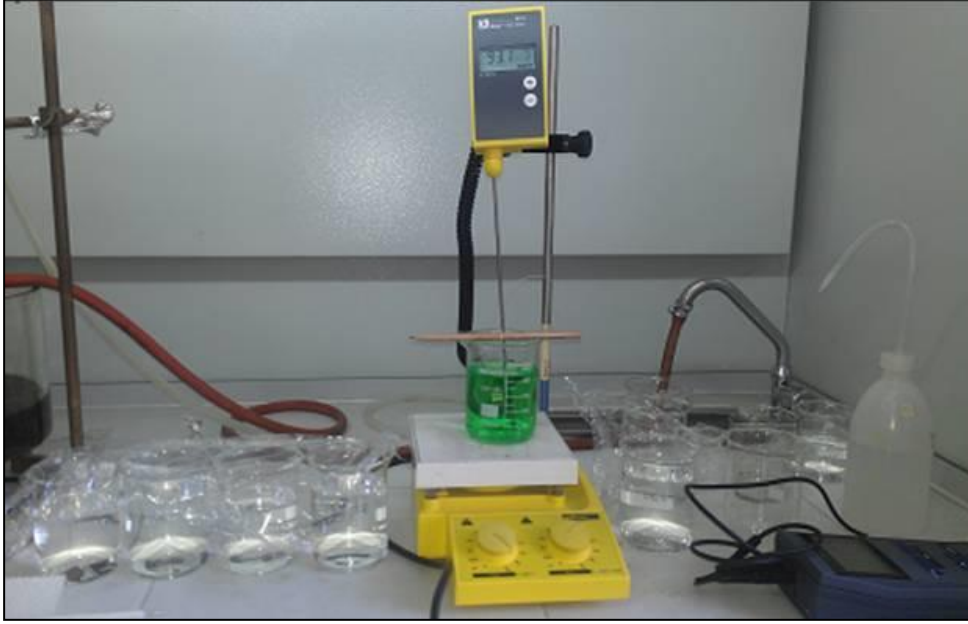
Şekil 4. 2 : Akımsız nikel fosfor kaplamanın hazır banyo kurulumu.
