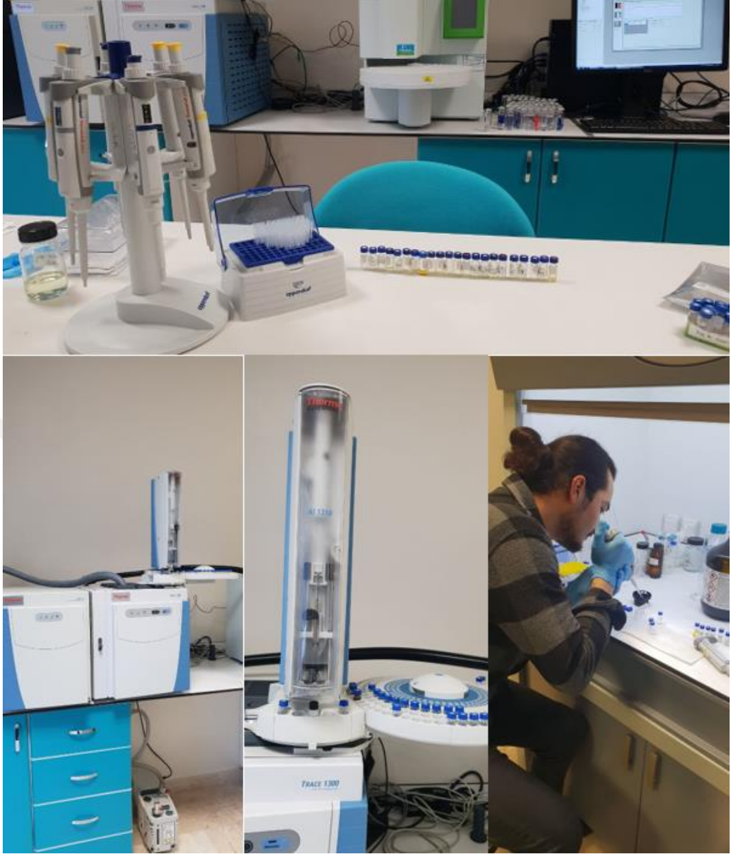
Fotoğraf 2.7. Gaz Kromotografi cihazı ile uçucu yağ bileşenlerinin belirlenmesi
