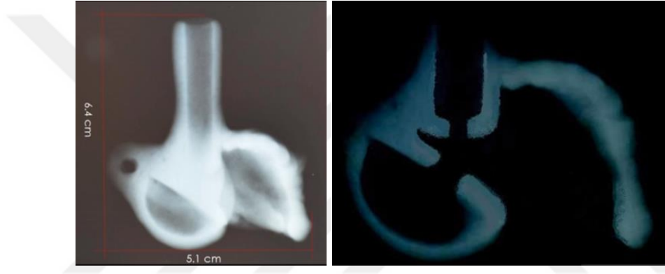
Görsel 120: Düdüğün X-Ray Görüntüsü ve Ses Mekanizması Çizimi
