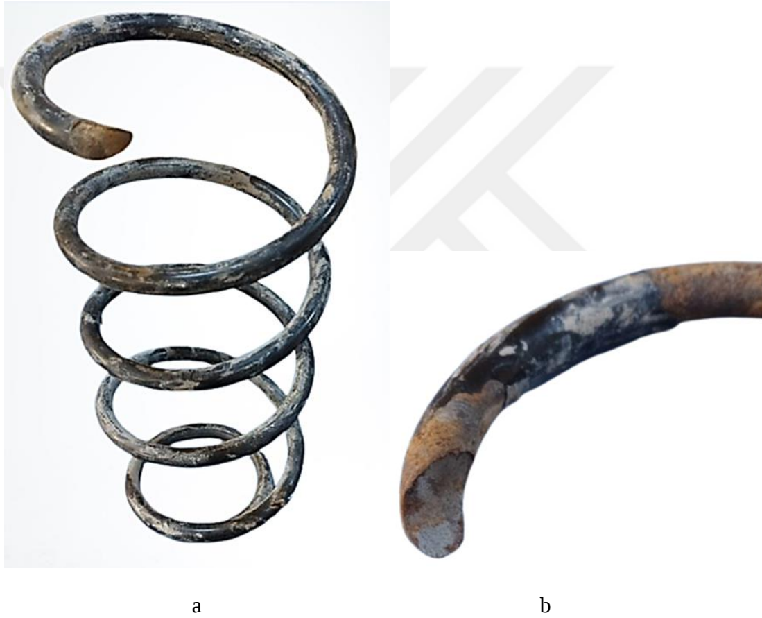
Şekil 5.4. (a) Kırılan amortisör yayı (b) kırılan karşı parçanın görünümü
