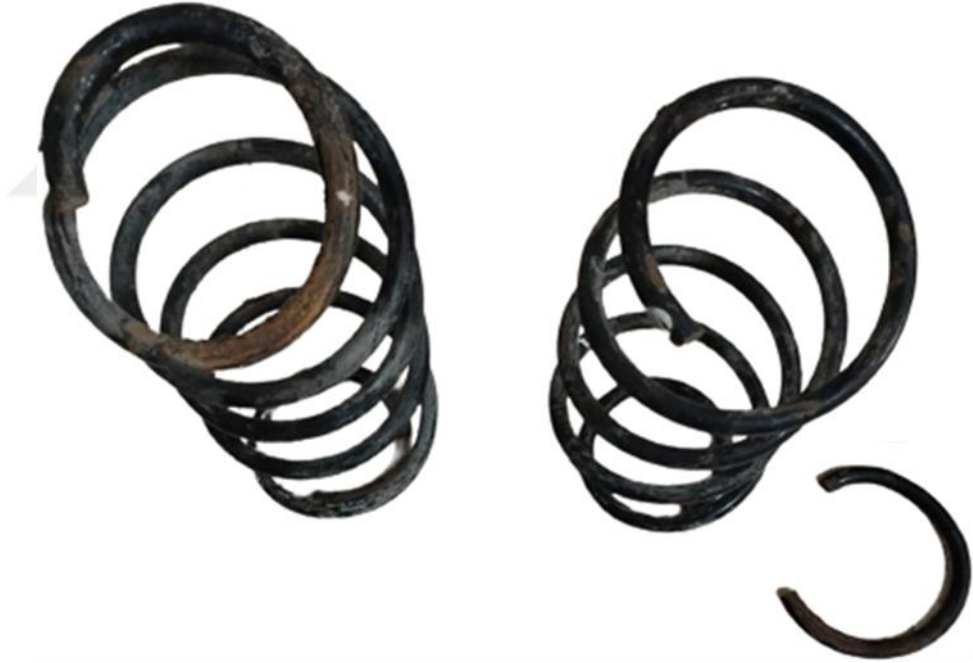
Şekil 3.1. Değiştirilen amortisör yayları
