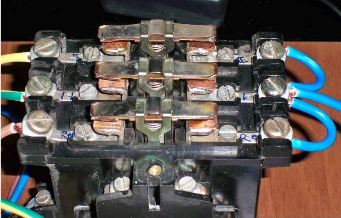
Şekil 4.15. Kontaktör uçlarına lehimlenmiş deney numunelerinin görünüşü
