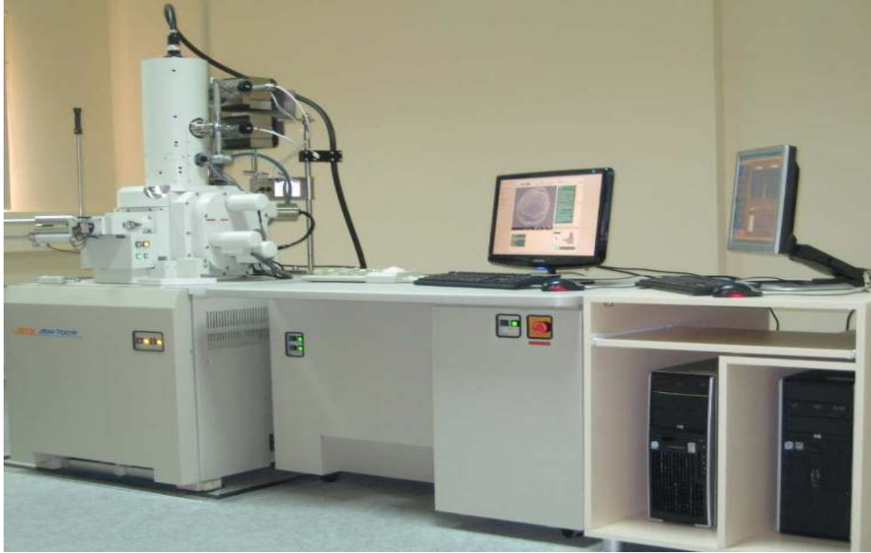
Şekil 4.18. Mikroyapı incelemelerinin yapıldığı JEUL marka taramalı elektron mikroskobu
