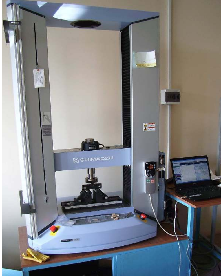
Şekil 4.12. Eğme deneylerinin yapıldığı üniversal deney makinesi
