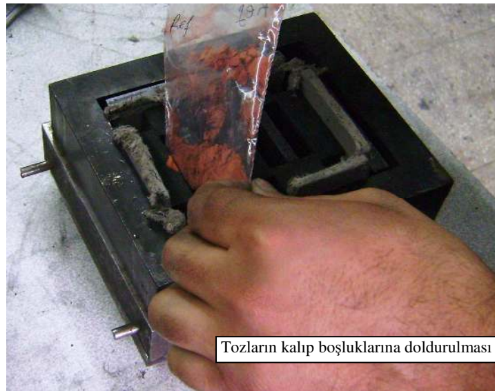
Şekil 4.4. Sıcak pres kalıplarının hazırlanışı
