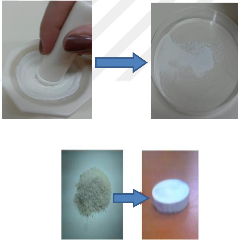
Şekil 3.5. Toz halindeki numunelerin bağlayıcı ile karıştırılıp pelet haline gelme işlemleri
