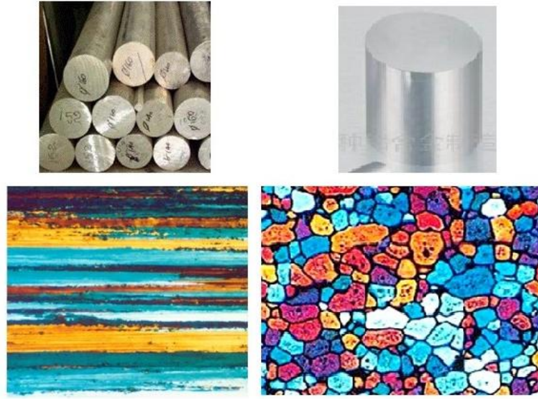
Şekil 4.11. Soğuk deformasyon ve sima yöntemi uygulanan alaşıma ait mikroyapılar [48]
