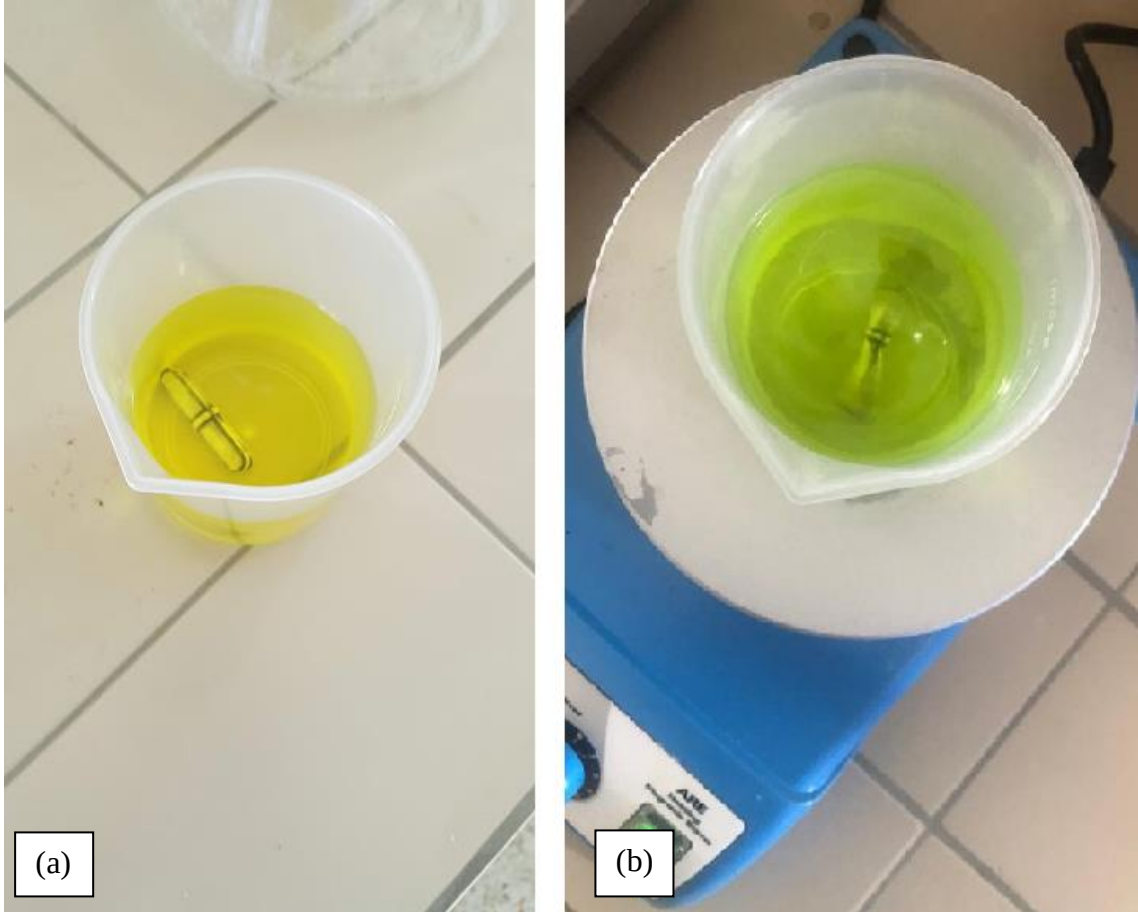
Şekil 3. 3. Sollerin son görünümü (a) %0,5 doplama yapılmış sol, (b) %5 doplama yapılmış sol
