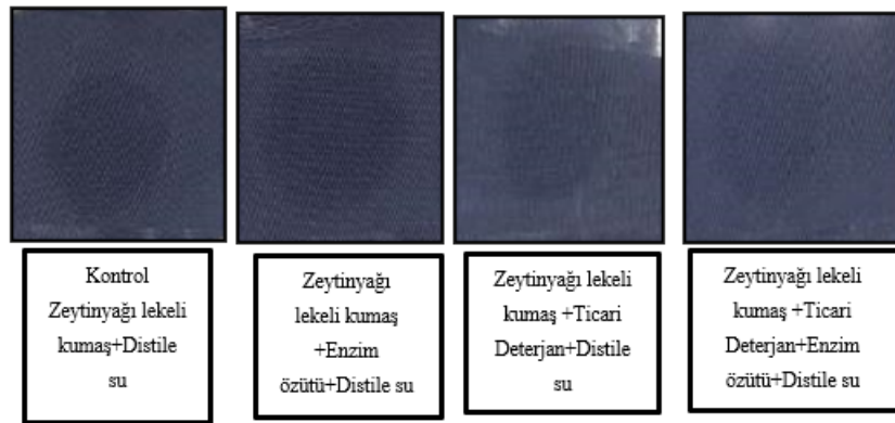
Şekil 25-a. B. pacificus 2NP6’ya ait saf lipazın pamuklu kumaştaki zeytinyağı lekesi çıkartma performansının ticari deterjanlarla karşılaştırılması.
