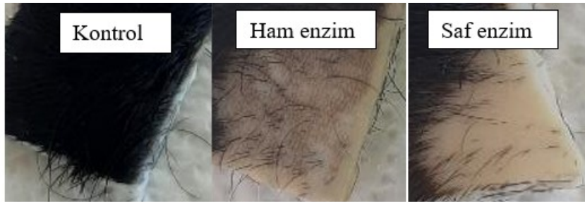
Şekil 23. B. pacificus 2NP6'dan elde edilen ham ve saf haldeki proteaz enzimi yardımıyla dana derisinden kıl giderimi.
