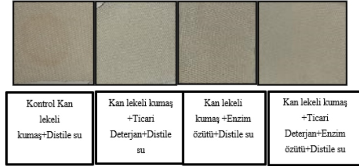
Şekil 24. B. pacificus 2NP6’ya ait saf proteazın pamuklu kumaştan kan lekesi çıkartma performansının ticari deterjanlar ile karşılaştırılması.
