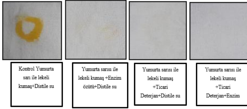
Şekil 25-b. B. pacificus 2NP6'ya ait saf lipazın pamuklu kumaştan yumurta sarısı lekesi çıkartma performansının ticari deterjanlar ile karşılaştırılması
