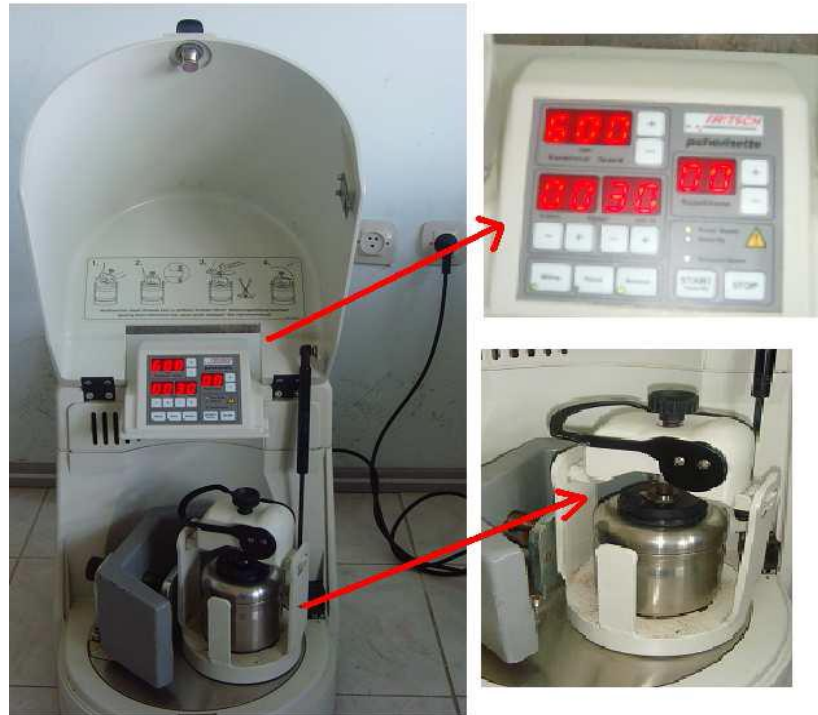
Şekil 4.5. Mekanik Aktivasyon işlemi için kullanılan gezegensel değirmen [26].
