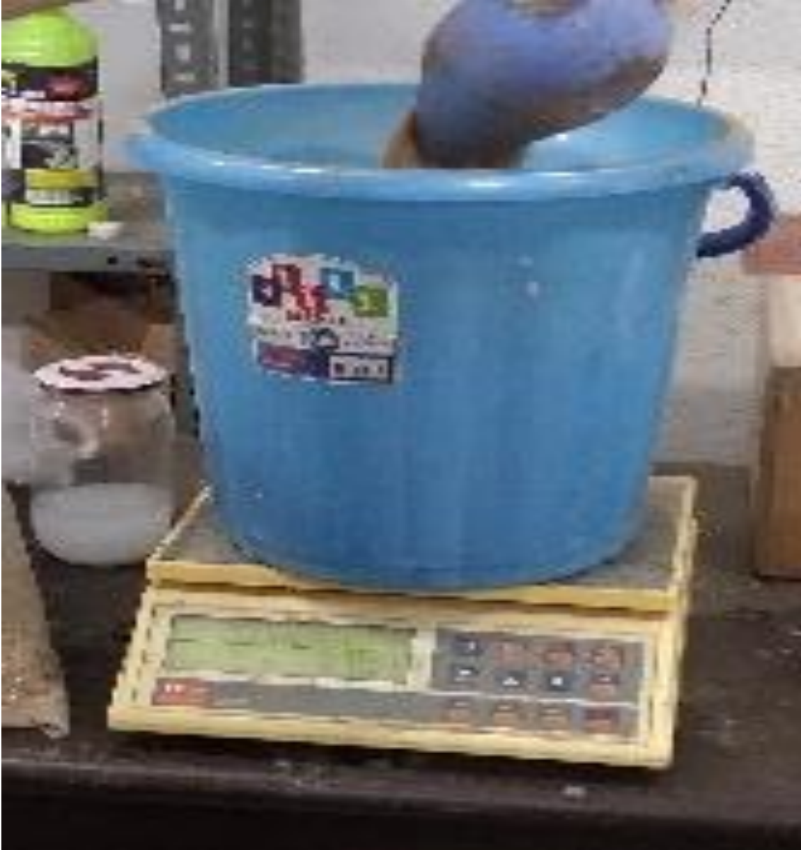
Şekil 4.7. Karışım kütlesi tartılması
