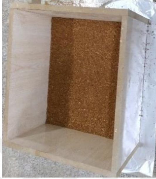
Şekil 4.13. Kalıp içine karışım dökülmesi
