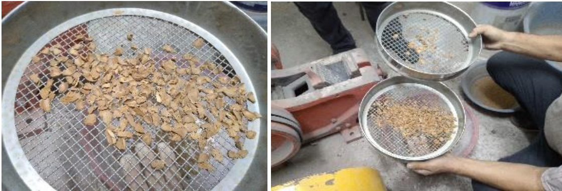
Şekil 4.3. Elek ile badem kabuklarının elenmesi
