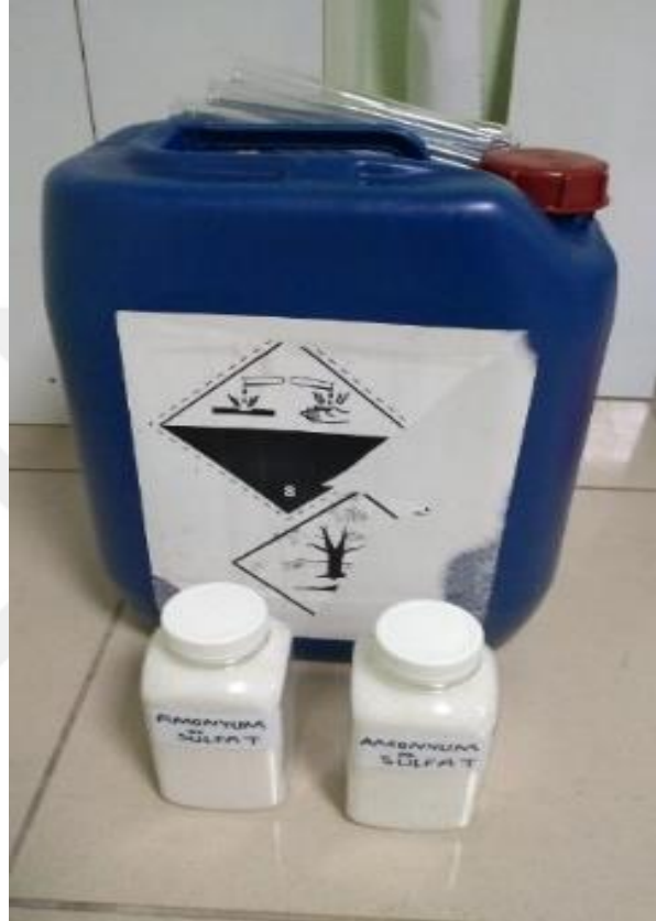
Şekil 4.19. % 55 oranlık üre formaldehit içeren tutkal ve sertleştirici amonyum sülfat
