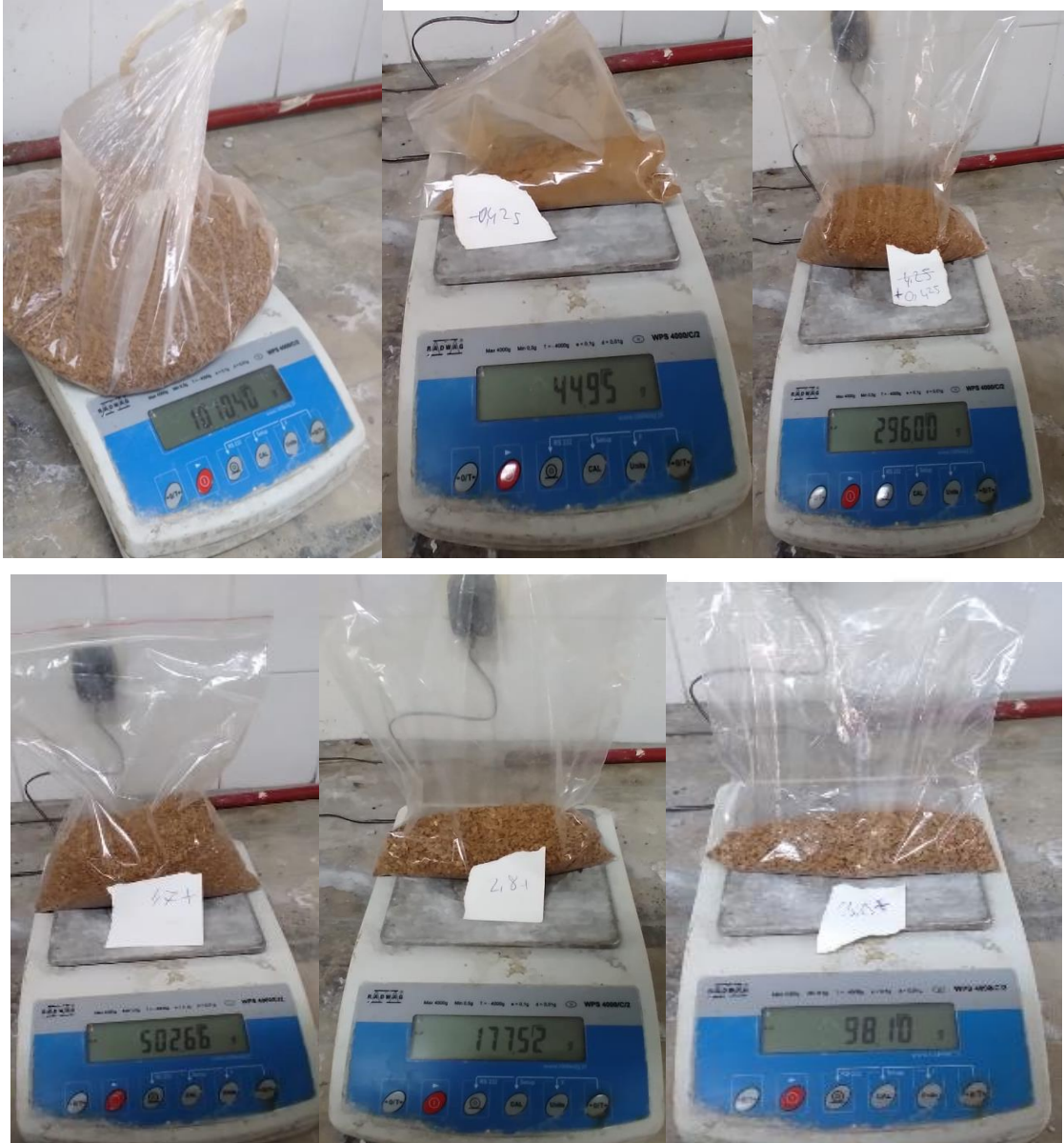
Şekil 4.4. 1 kg öğütülmüş badem kabuğunun 0,425 mm altı, 0,425 mm üstü, 1,7 mm üstü, 2,8 mm üstü, 3,35 mm üstü tartılmış kütleleri
