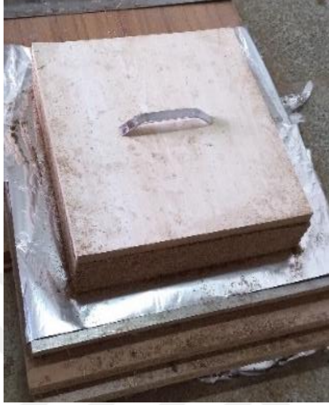
Şekil 4.14. Kalıbın kenarlarının kaldırılması sonrası oluşan görünüm
