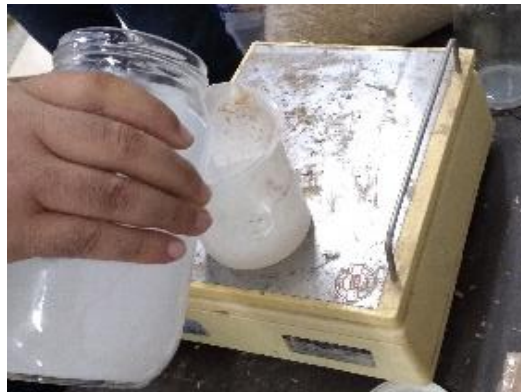
Şekil 4.8. Tutkal kütlesi tartılması
