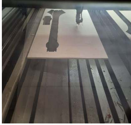
Şekil 3.2. Huş kontrplak malzemenin CNC lazer ile kesimi
