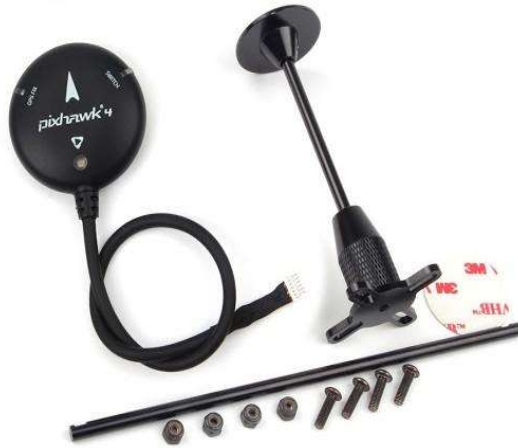
Şekil 3.15. GPS konumlama modülü
