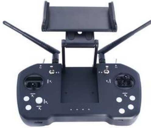
Şekil 3.17. Radyo kumanda alıcı ve verici modülü
