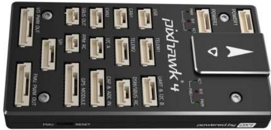
Şekil 3.13. Uçuş Kontrol Kartı (Pixhawk 4)
