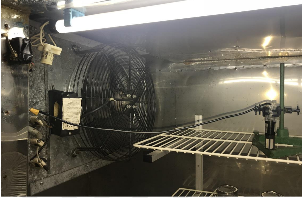
Şekil 3.13. Kuru hava ısıtıcısı, sıcaklık ve % bağıl nem probu
