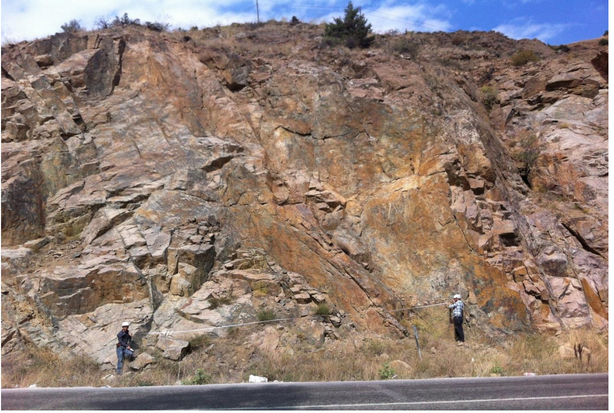
Şekil 3. 15. Granitoyidlerde yapılan hat etüdü çalışmaları
