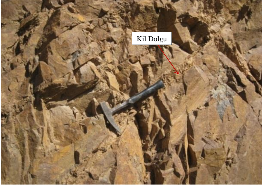
Şekil 3.24. Süreksizliklerde gözlenen kalsit ve kil dolgu
