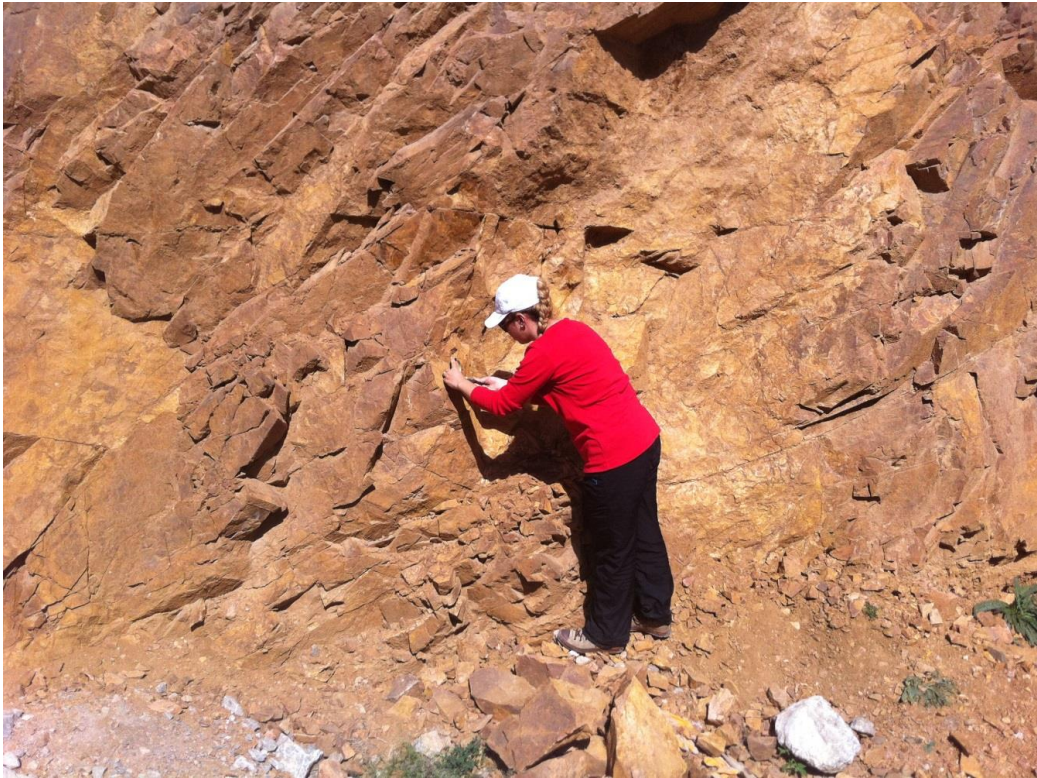
Şekil 3.16. Granitoyidlerde süreksizlik setlerini belirlemek için alınan yönelim ölçüleri
