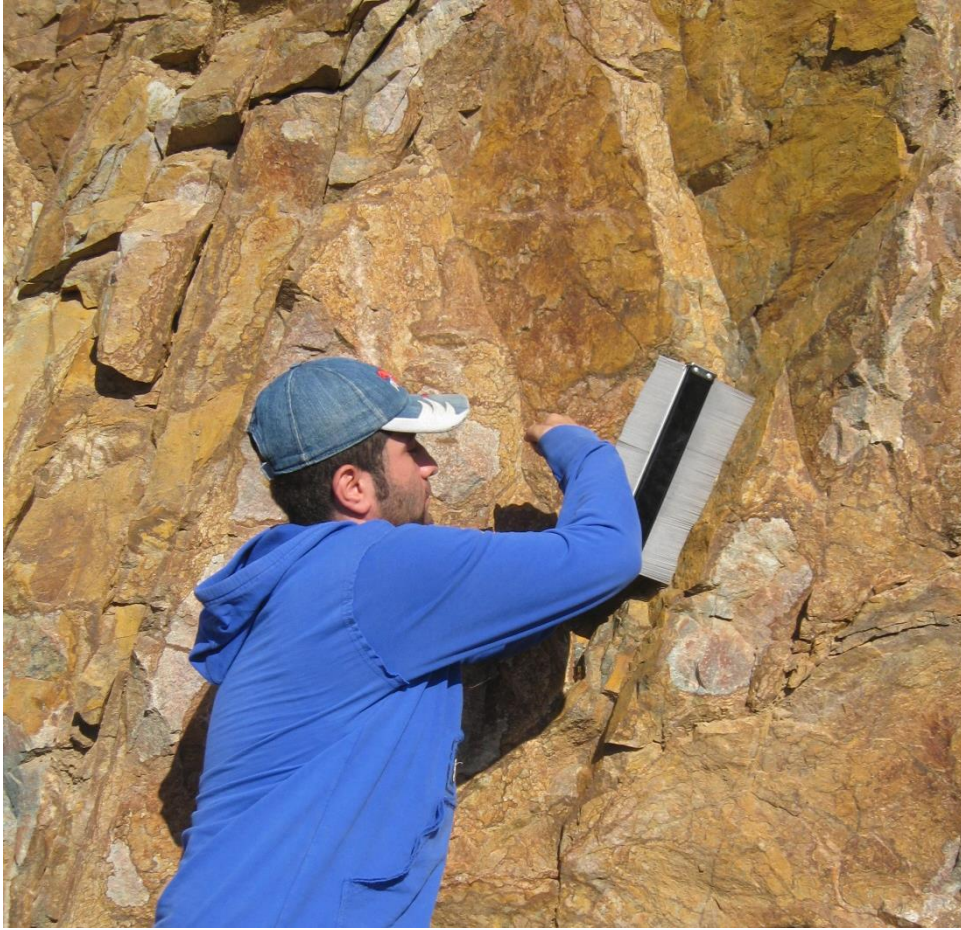
Şekil 3.20. Kaya şevlerindeki süreksizliklerden alınan pürüzlülük ölçüleri
