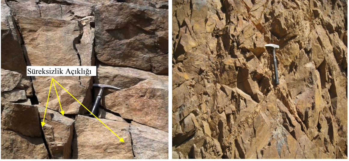
Şekil 3.23. Granitoyidlerde gözlenen süreksizlik açıklığından bir görünüm
