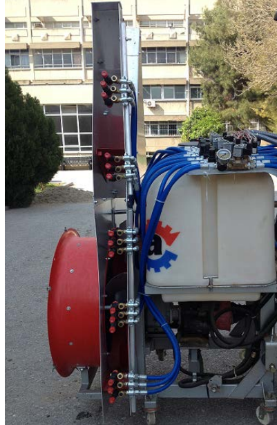
Şekil 3.24 Kule tipi püskürtme rampasına dikey hizada dizilip kelepçeli bağlantılarla sabitlenen püskürtme memeleri
