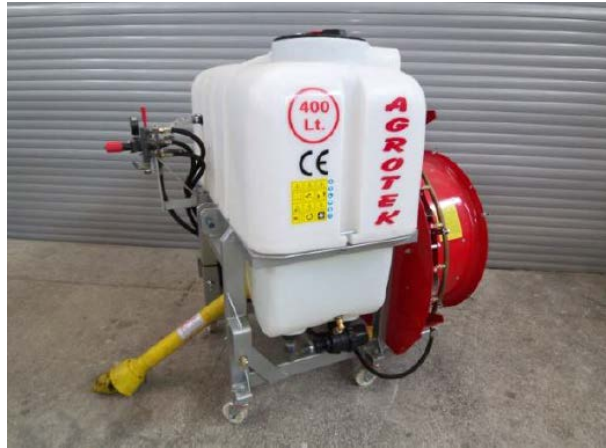
Şekil 3.1 Modifiye edilen yardımcı hava akımlı bağ-bahçe pülverizatörü.
