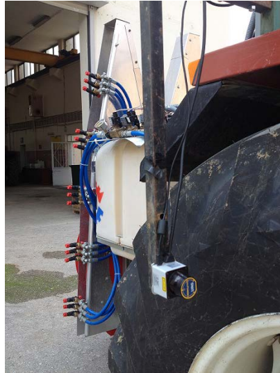
Şekil 3.31 Lazer sensörün pülverizatörün ön kısmında, traktör yan tarafındaki konumu
