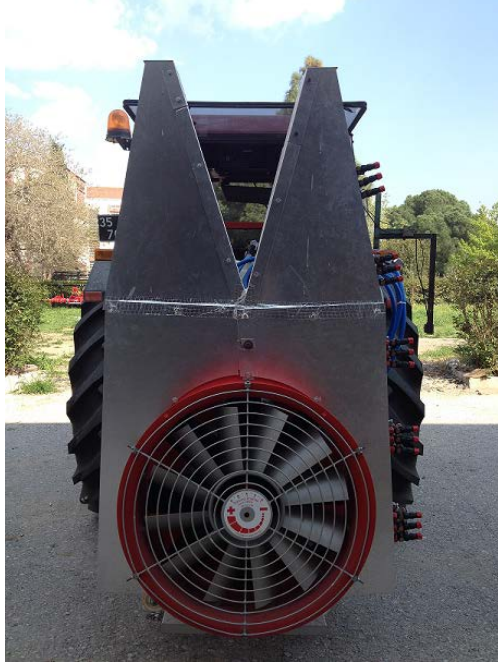
Şekil 3.23 Kule tipi püskürtme rampası.
