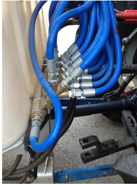
Şekil 3.27 Ana iletim hortumuna bağlanan 5'li kollektör, 3'lü dağıtıcılar ve bunlara bağlanmış yüksek basınç hortumları
