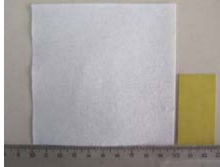
Şekil 3.15 Denemelerde kullanılan filtre kâğıdı ve suya duyarlı kâğıt.
