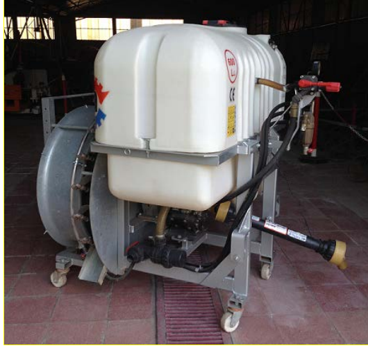
Şekil 3.2 Geleneksel yardımcı hava akımlı bağ-bahçe pülverizatörü.
