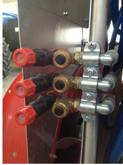
Şekil 3.25 1 adet 1 mm, 2 adet 1,5 mm ölçülerinde meme plakasından oluşan meme grubu
