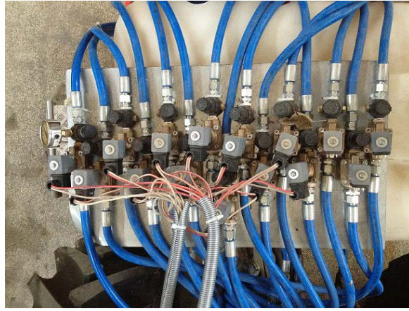
Şekil 3.29 Solenoid valf ve basınç regülatörlerinin bağlandığı sac levhanın depo üzerinde üstten görünümü
