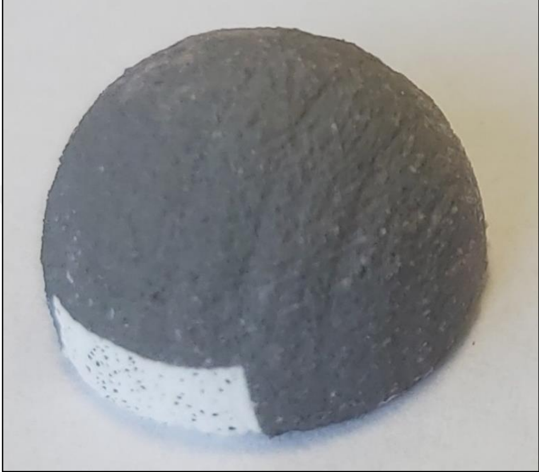
Şekil 4.2. U100 sinterlenmiş hali (SEM öncesi kaplama yapılmıştır)
