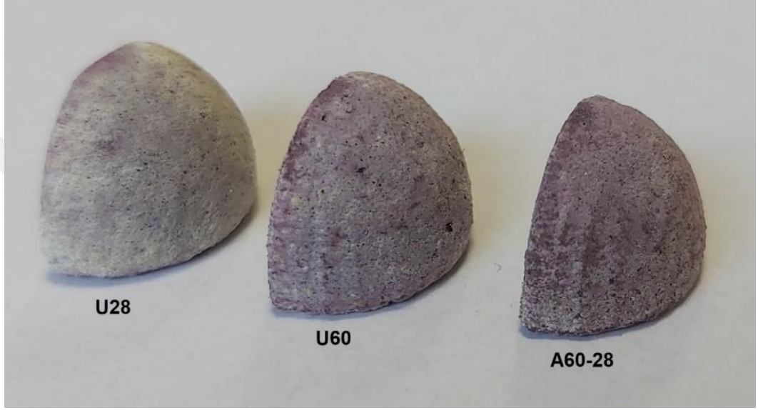
Şekil 4.28. Adaptif numunenin katman kalınlıkları (0,028 – 0,06 mm)
