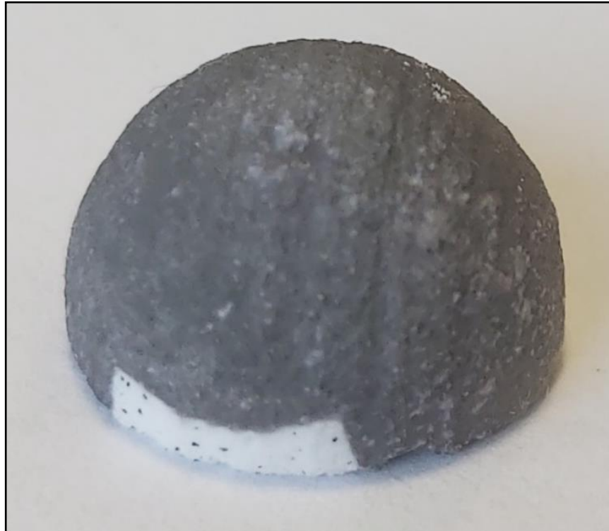
Şekil 4.8. A18:100-44'ün sinterlenmiş hali (SEM öncesi kaplama yapılmıştır)
