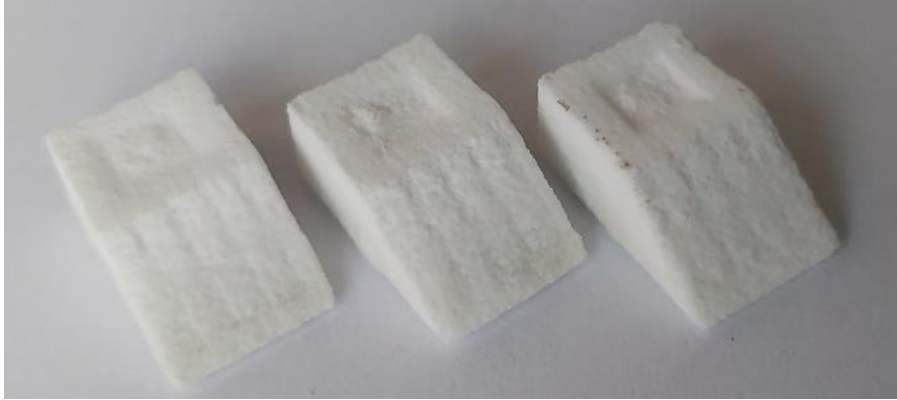
Şekil 4.33. Katman kalınlığı 225 \mu\text{m} ve %50 doygunluktaki numunenin sinterlenmiş hali
