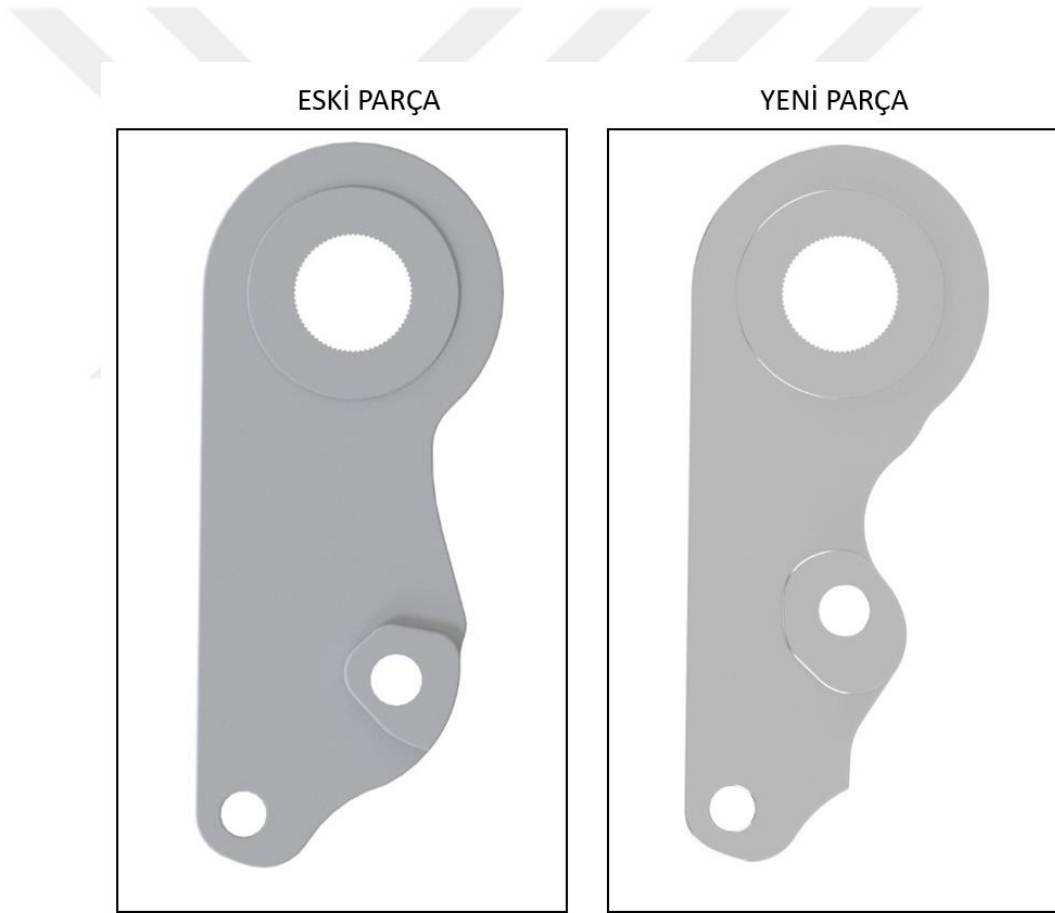
Şekil 3.16 (a) Eski yönlendirme kolu alt parçası (b) Yeni yönlendirme kolu alt parçası
