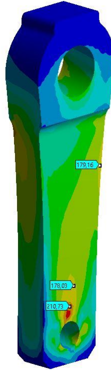
Şekil 5.24 Pitman kolu statik analiz gerilme değerleri
