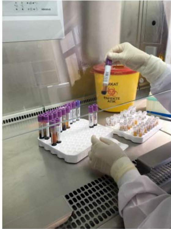
Resim 3: Sınıf II güvenlik kabininde plazmanın ayrılması
