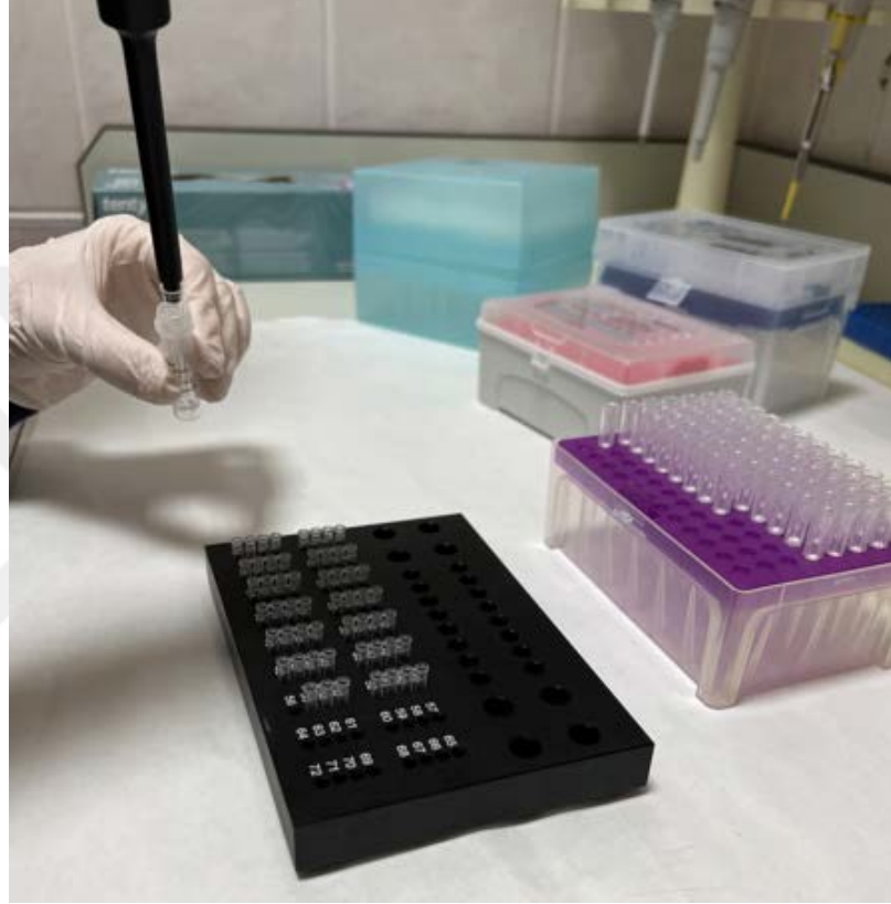
Resim 5: Master miks hazırlanması ve PZR tüplerine aktarılması
