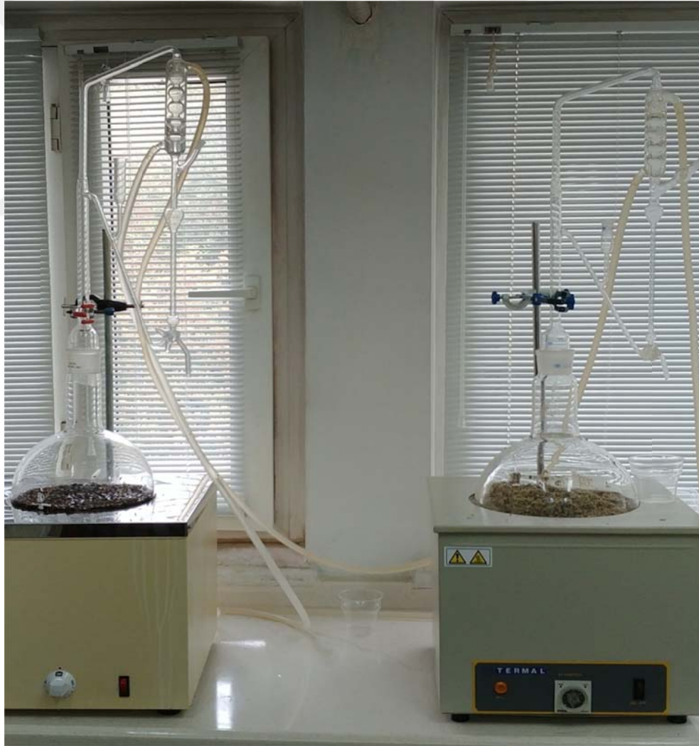
Şekil 3.4. Clevenger Cihazı (ikili)
