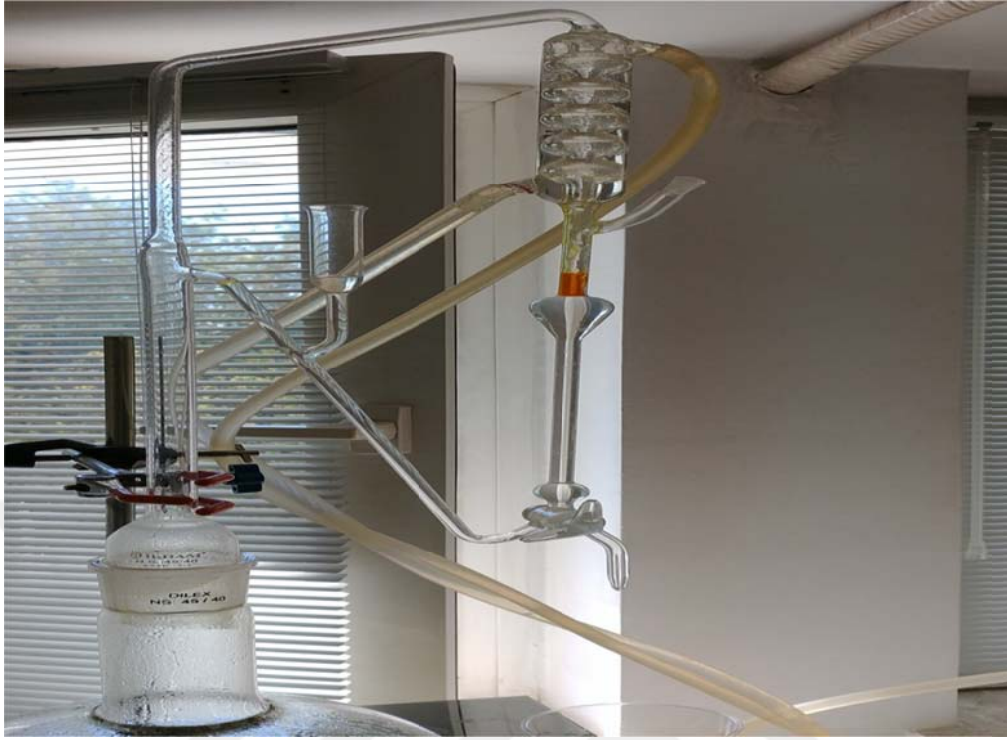
Şekil 3.11. O. minutiflorum yağının damıtılma işlemi
