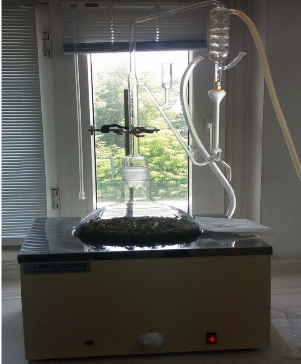
Şekil 3.5. Clevenger Cihazı (tekli)
