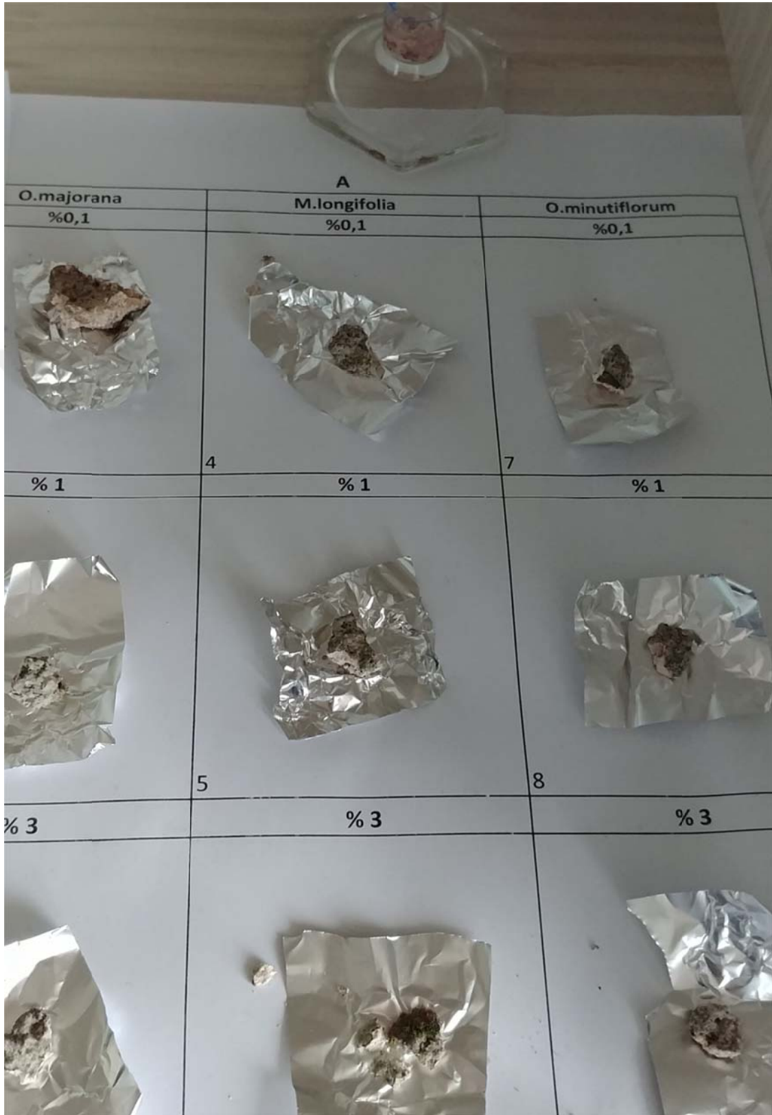
Şekil 3.23. TTC testi uygulanmadan önce taş numuneleri
