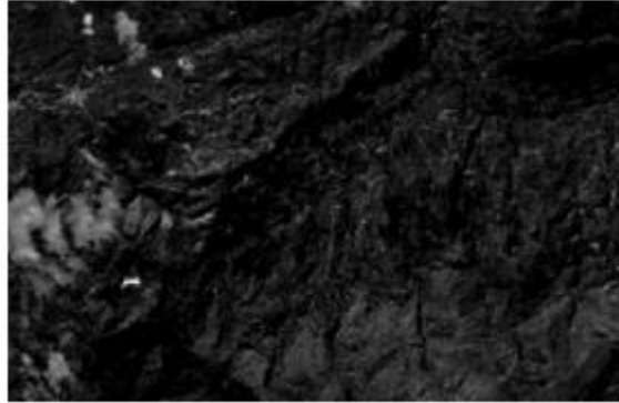
Şekil 6.2. Demirli minerallerin tespitini sağlayan band oranları(4/5)
