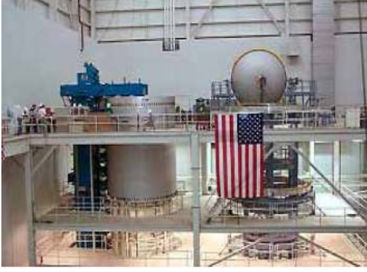
Şekil 3.19. Space Shuttle External Tank projesi ve Marshall Space Flight Center laboratuvarındaki Sürtünme Karıştırma Kaynak sistemlerinden görüntüler [12,13,25]
