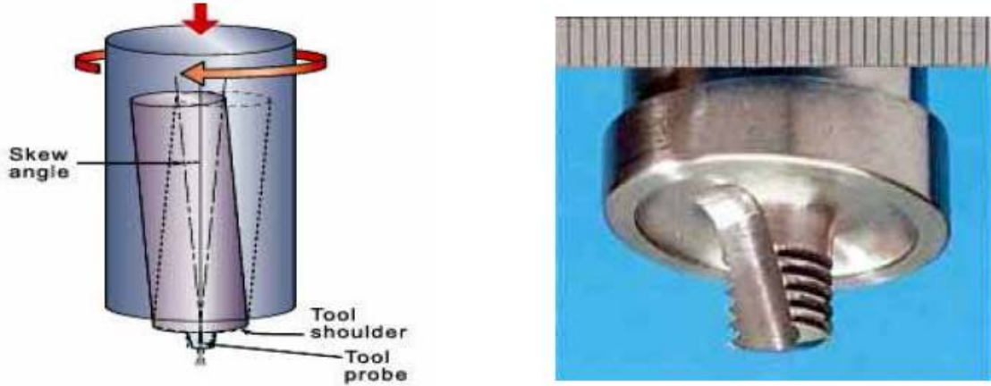
Şekil 3.13. Skew-Stir takımının çalışma prensibi ve A-Skew takımının resmi [25]
