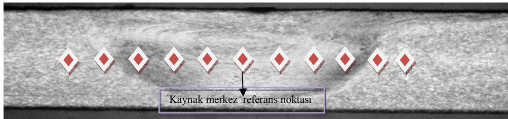
Şekil 5.13.Mikrosertlik ölçüm noktalarının şematik gösterimi
