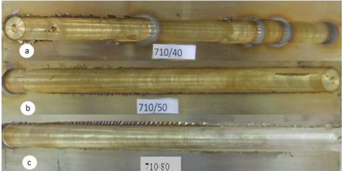
Şekil 5.5. 710d/ d' da farklı ilerleme hızlarında birleştirilmiş pirinç levhalar. a-40 mm/d, b-50mm/d, c-80mm/d
