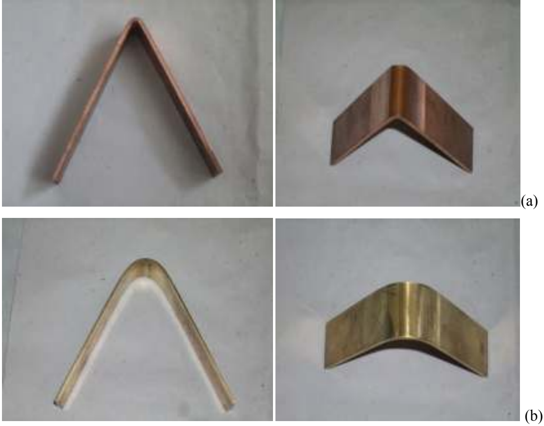
Şekil 5.12. Eğme deneyi sonrası numunelerin görünümü; (a)Cu-Cu, (b)pırınç-pırınç
