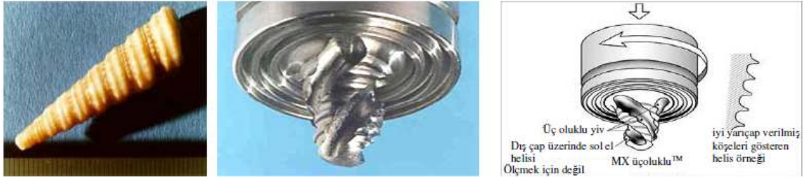
Şekil 3.10. MX Triflute™ takımın resim ve şematik çalışma şekli [13] (MX Triflute™ takımın esin kaynağı deniz kabuklarıdır)
