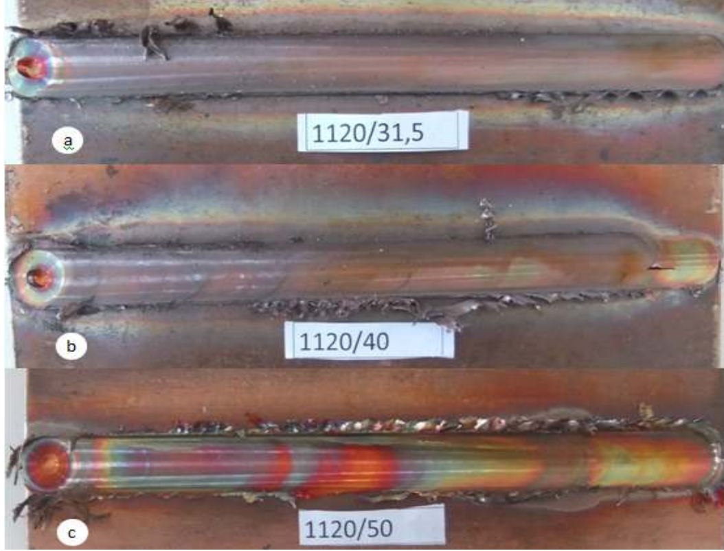
Şekil 5.4. 1120d/d' da farklı ilerleme hızlarında birleştirilmiş bakır levhalar. a-31,5 mm/d, b-40mm/d, c-50mm/d
