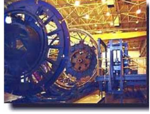
Şekil 3.19. Space Shuttle External Tank projesi ve Marshall Space Flight Center laboratuvarındaki Sürtünme Karıştırma Kaynak sistemlerinden görüntüler [12,13,25]
