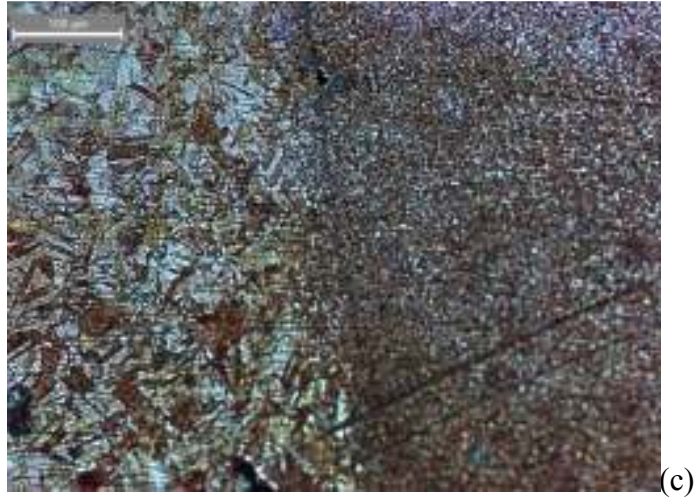
Şekil5.50. 710d/d-80mm/d çalışma şartlarında yapılan pirinç-pirinç SKK kaynağı, (a)tane sınırı x200 sağ taraf, (b)karışım bölgesi x50 merkez, (c) tane sınırı x200 sol taraf
