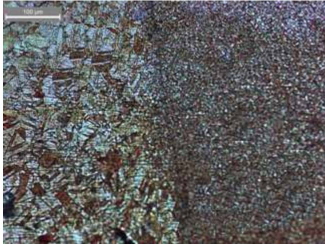
Şekil5.54. 1120d/d-40mm/d çalışma şartlarında yapılan pirinç-pirinç SKK kaynağı, (a)tane sınırı x200 sağ taraf, (b)karışım bölgesi x50 merkez, (c) tane sınırı x200 sol taraf
