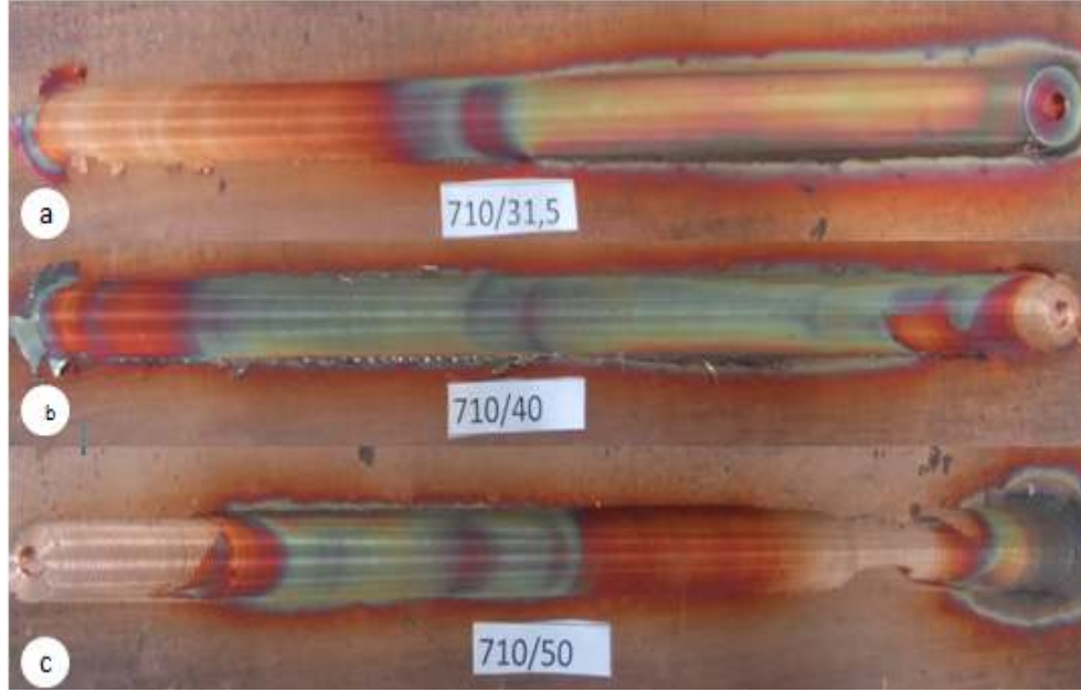
Şekil 5.2. 710d/d' da farklı ilerleme hızlarında birleştirilmiş bakır levhalar. a-31,5 mm/d, b-40mm/d, c-50mm/d
