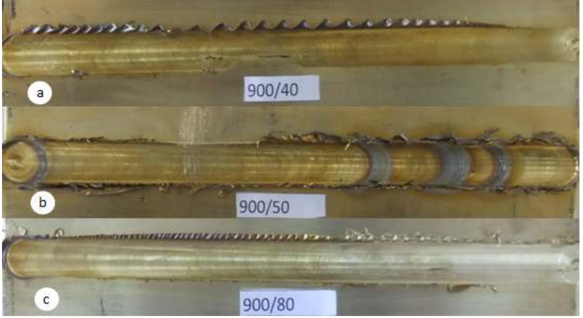
Şekil 5.6. 900d/ d' da farklı ilerleme hızlarında birleştirilmiş pirinç levhalar. a-40 mm/d, b-50mm/d, c-80mm/d
