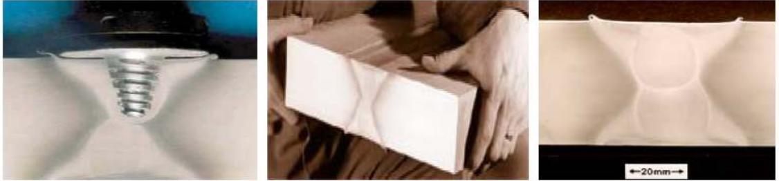
Şekil3.9. 75 mm kalınlığındaki AA6082T6 alaşımının kaynağında Whorl™ takımının kullanılması, kaynağın bitmiş hali ve kaynak dikişinin görüntüsü [13]
