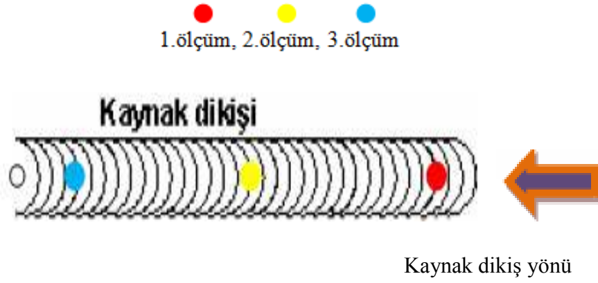
Şekil 5.35. Yüzey pürüzlülük ölçümde izlenilen yöntem
