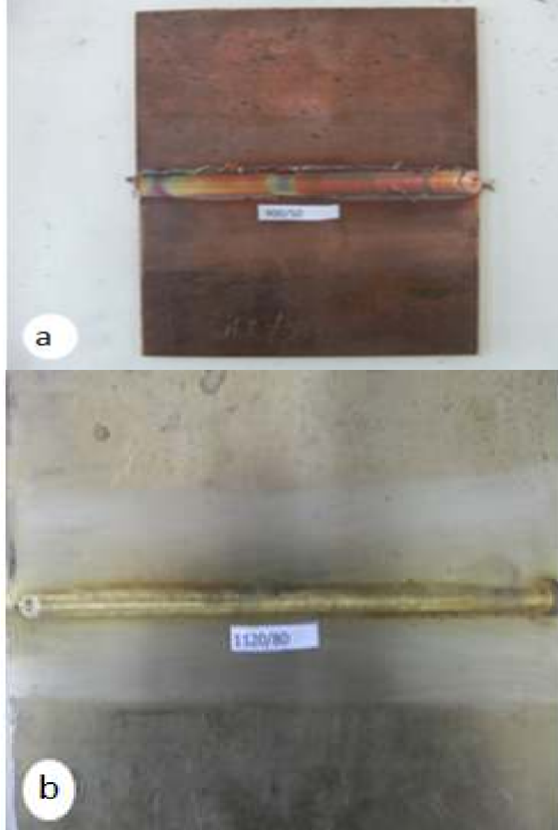
řekil 5.1. sürtünme karıřtırma kaynaęı ile kaynaklamıř malzeme grupları a- Bakır-bakır grubu b-Pirinç-pirinç grubu
