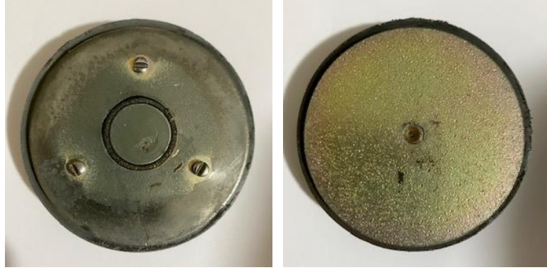
Görsel 5.5 Cüruf içerisinde metalik demirin alınmasında kullanılan mıknatıs
