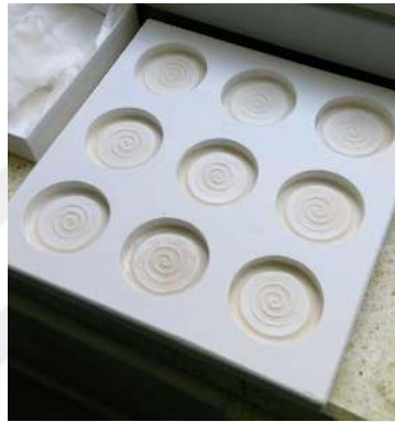
Görsel 5.2 Deneme plakaları için hazırlanan alçı kalıp
