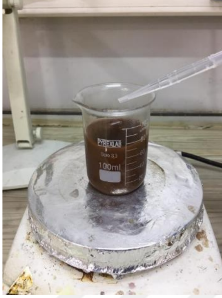
Şekil 31. Bakır tozlarının indirgeyici ajan çözeltisi içerisinde karıştırılması
