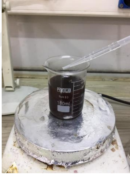
Şekil 32. Gümüş kaynağı çözeltisinin ilave edilmesi
