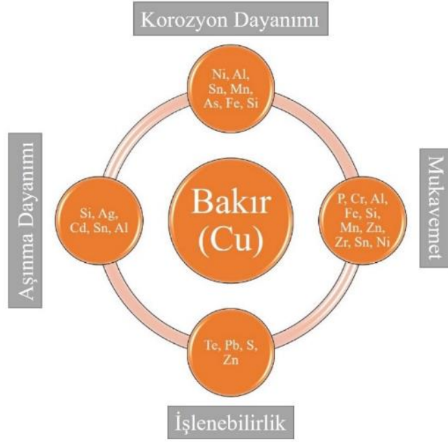
Şekil 5. Alaşım Elementlerinin Bakırın Mekanik Özelliklerine Etkisi
