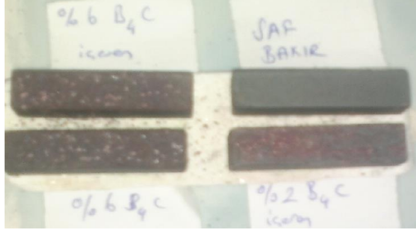
Şekil 2.5.Sinterleme işleminden çıkan numunelerin görünümü
