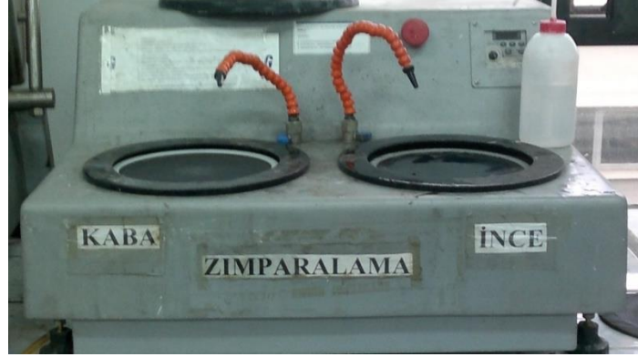
Şekil 2.7. Yarı otomatik zımparalama makinası
