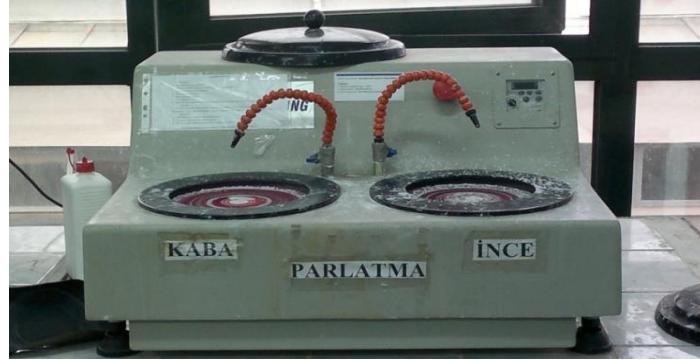
Şekil 2.8. Yarı otomatik parlatma makinası
