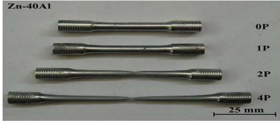
Şekil 2.3. Zn-40Al alaşımlarının EKAP paso sayısına göre yüzde uzama miktarındaki değişim (Purcek vd 2008)
