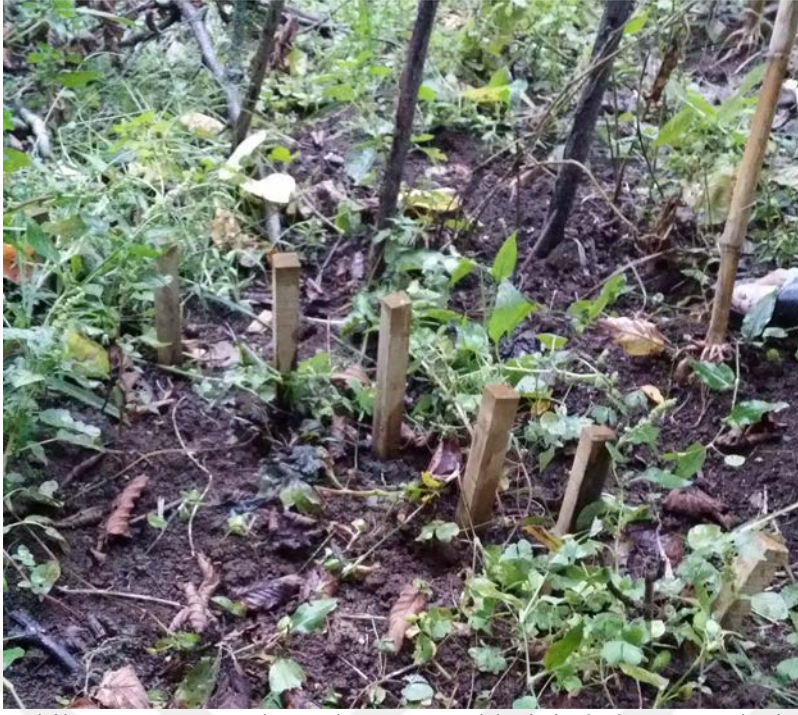
Şekil 8. 2x2x30 cm boyutlu çıta örneklerinin bahçede yerleşimi.
