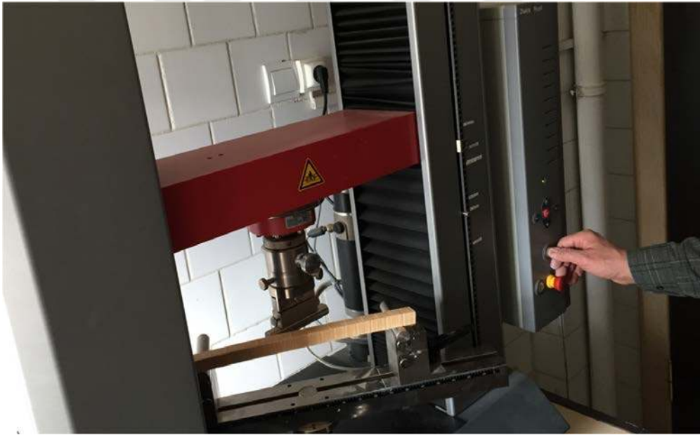
Şekil 10. Universal test cihazı (Gümüşhane MYO Ormancılık Laboratuvarı)
