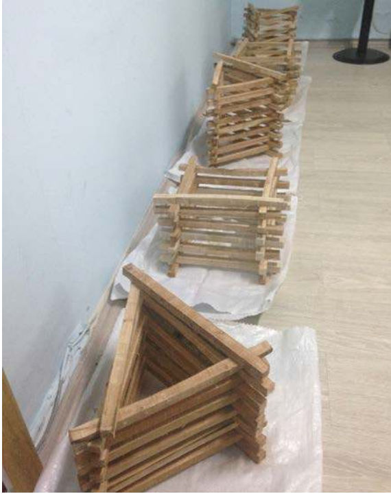
Şekil 4. 2x2x30 boyutlarında farklı çeşitlerden hazırlanmış fındık odun örneklerinin kondisyonlama odasındaki görüntüsü.
