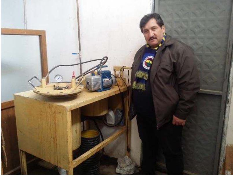
Şekil 5. Açık alan örneklerinin dolu hücre yöntemine göre empenyesinde kullanılan empenye düzeneği.
