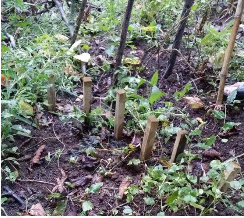
Şekil 8. 2x2x30 cm boyutlu çıta örneklerinin bahçede yerleşimi.
