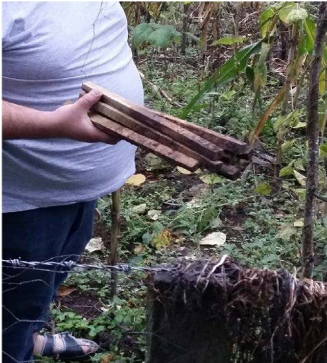
Şekil 9. Odunların ilk 6 aylık muayenesinde araziden çıkarılması (07 Ekim 2022)
