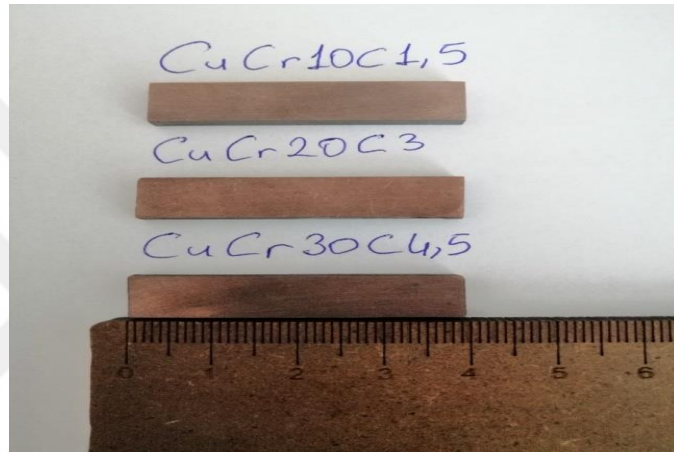
Şekil 6.6. SPS’de 40x10x4 mm ölçülerinde hazırlanan numuneler
