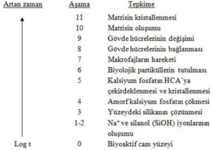
Şekil 4.2: Biyocam yüzeyinde gerçekleşen tepkimelerin aşamaları[37].
