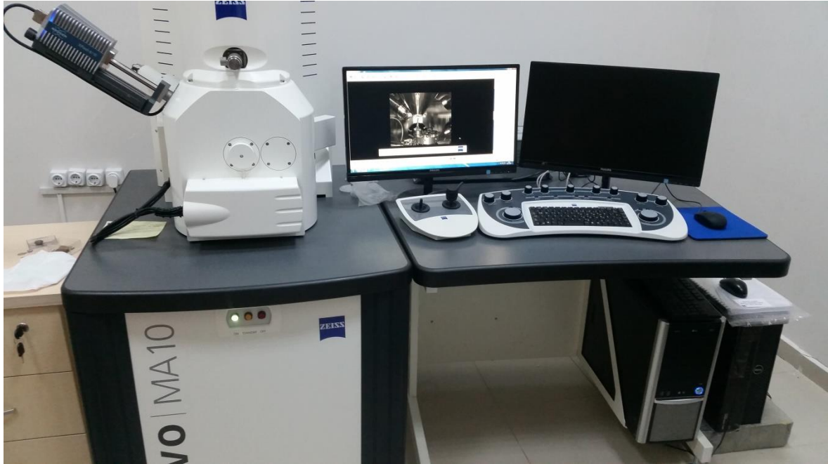
ekil 2.3. PLGA mikrosferlerin taramalı elektron mikroskop ile analizi
