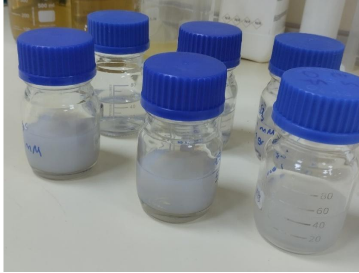
Şekil 3.9. Farklı \text{AgNO}_3 konsantrasyonlarıyla hazırlanan bakteriyel süspansiyonların, inkübasyondan iki gün sonra gözlenen renk değişimlerini gösteren ön deneme tüpleri.
