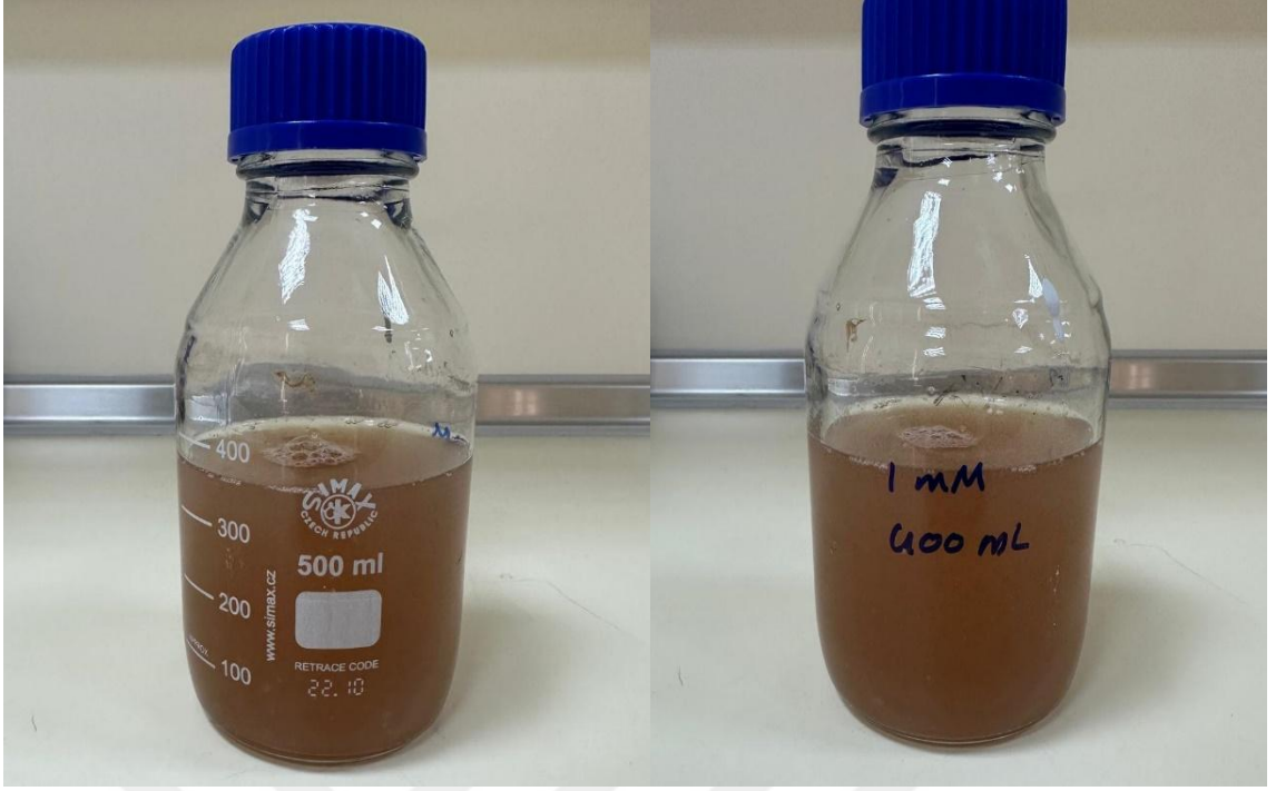
Şekil 3.6. \text{AgNO}_3 çözeltisi ile P. Fluorescens peletinin birleştirilmesinin 7. günü gözlenen renk değişimi.
