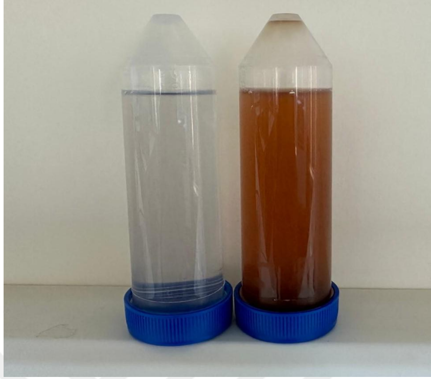
Şekil 3.7. Sadece \text{AgNO}_3 çözeltisi (kontrol) ve \text{AgNO}_3 ile P. Fluorescens peletinin birleşiminden elde edilen süspansiyonların renk karşılaştırılması
