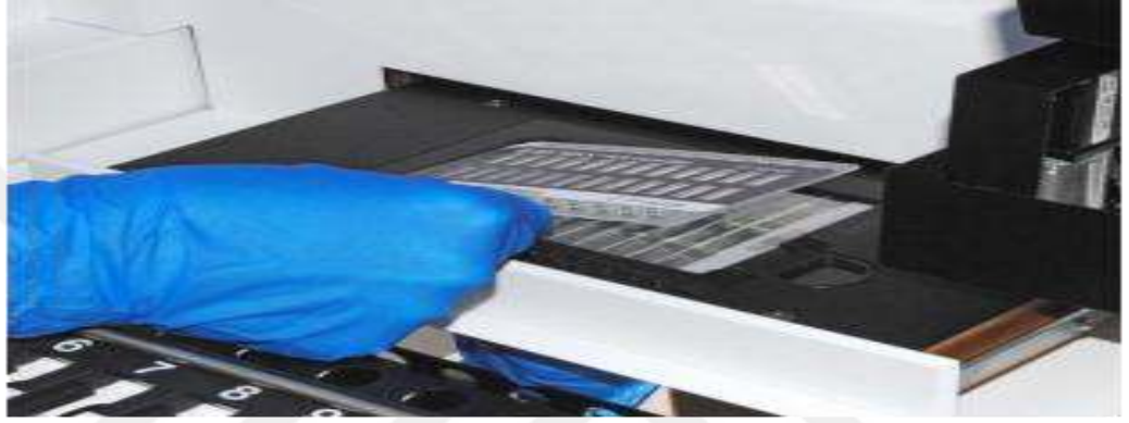
Resim 3.2. PCR kartuşlarının cihaza yerleştirilmesi
