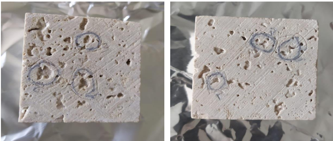
Şekil 4.1: \text{CaCl}_2 \cdot 2\text{H}_2\text{O} (60 gr/L) içeren CaÜ besiyeri ve \text{Ca}(\text{C}_2\text{H}_3\text{O}_2)_2 (6 gr/L) içeren CAGMÜ besiyerinde bekletilmiş, karbonlanmış ve canlı bakteri uygulanmış mermer numunelerinin makroskobik görünüşleri.
