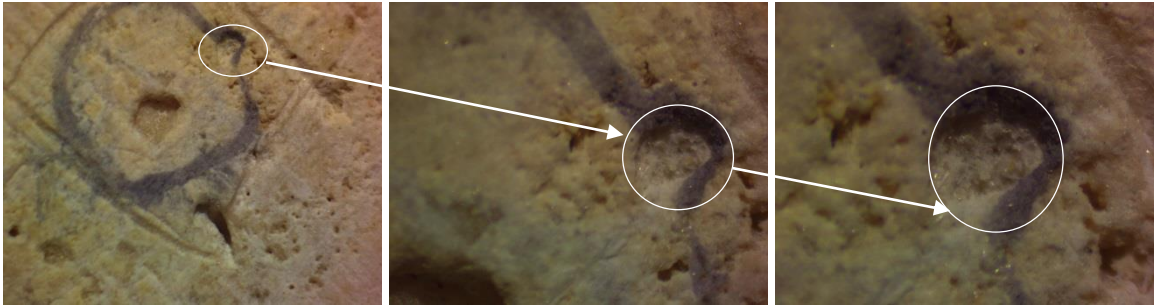
Şekil 4.7: \text{CaCl}_2 \cdot 2\text{H}_2\text{O} (60 gr/L) içeren CaÜ besiyerinde, ölü bakteri uygulanan mermer numunelerinin 10, 30 ve 45 büyütme ile incelenen stereo mikroskop görüntüsü (6. grup).
