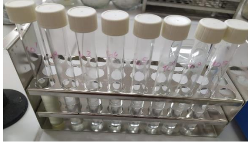
Şekil 3.5: Canlı hücre sayımı için seri sulandırım işleminin yapılmış tüpleri.
