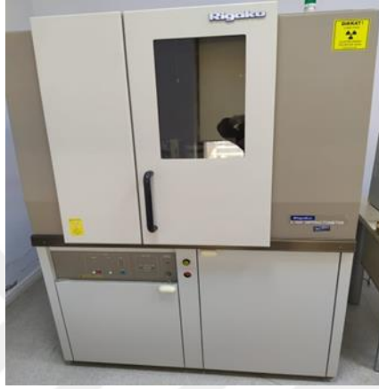
Şekil 3.12: İBTAM laboratuvarında bulunan XRD cihazının görünümü.
