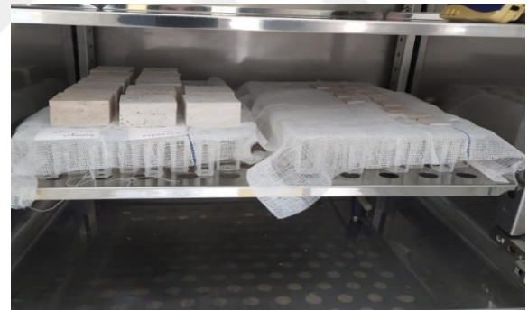
Şekil 3.11: Mermer numunelerin etüvde bekletildikten sonra bekleme koşullarına alınması.
