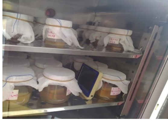
Şekil 3.10: Farklı presipitasyon besiyerlerine konulan mermer numunelerin etüvde bekletilmesi.
