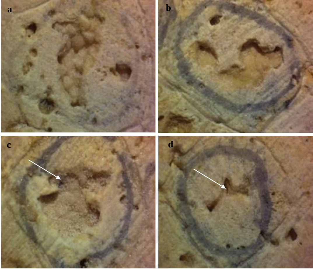
Şekil 4.3: \text{CaCl}_2 \cdot 2\text{H}_2\text{O} (60 gr/L) içeren \text{Ca}\ddot{\text{U}} besiyerinde bekletilmiş, karbonlanmış a) Kontrol (7. grup), b) Sadece besin içeren 2. grup, c) Canlı bakteri uygulanan 4. grup, d) Ölü bakteri uygulanan 6. Grup (10 kez büyütme).
