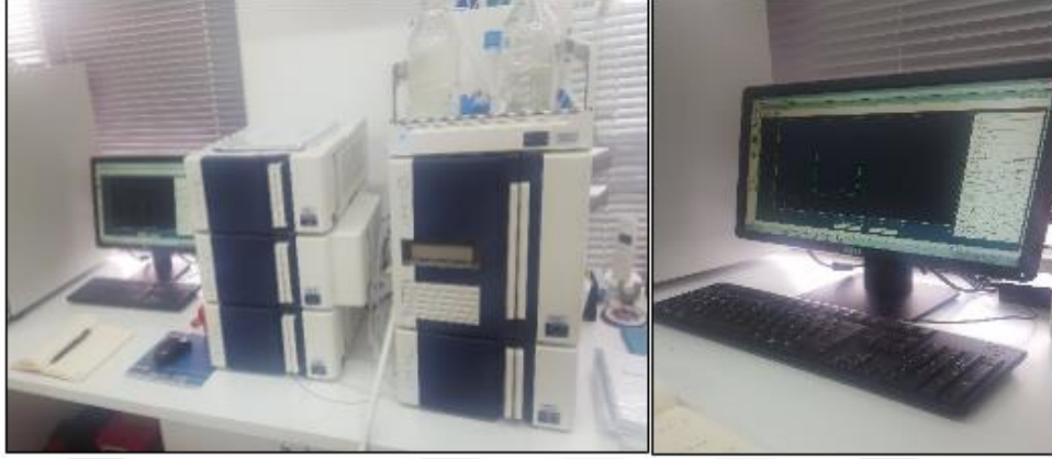
Şekil 3.7. Arı zehri içerik analizi için kullanılan HPLC analiz cihazı.
