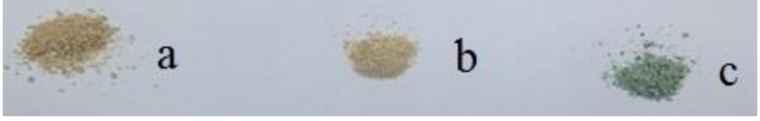
Şekil 4.1. Bal kabağı kabuğunun (a) Normal, (b) KOH işlenmiş ve (c) KOH modifikasyonlu adsorbent ile \text{Cu}^{+2} 'lu giderimi
